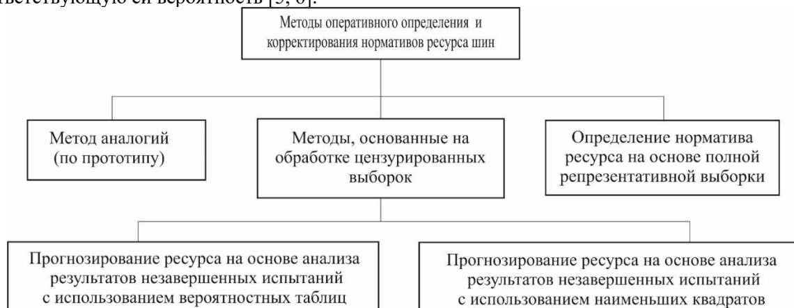
Рисунок 1 – Методы оперативного определения и корректирования нормативов ресурса шин
