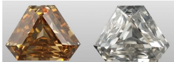
а) б) Расми 4. Ивасзавии қаҳварангии алмос бо ранги сафед дар натиҷаи коркард зери фишор ва ҳарорат. а) то коркарди ҳароратӣ; б) баъд аз коркарди ҳароратӣ
