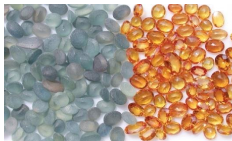
Расми 2. Тағйирёбии ранги сабзҷатоби берилл ба ранги зард ҳангоми таъсири гармӣ
