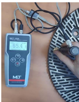
Рисунок 2. Измерение твердости поверхности ножевой гарнитуры с помощью мобильного твердомера
