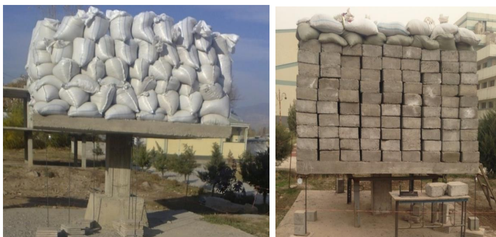
Расми 9. Боргузорию ниҳии бандҳои пайвасти плита бо сутуни синҷи биболор бо армирони муқаррарӣ ва композитӣ – 32 \text{ кН/м}^2
