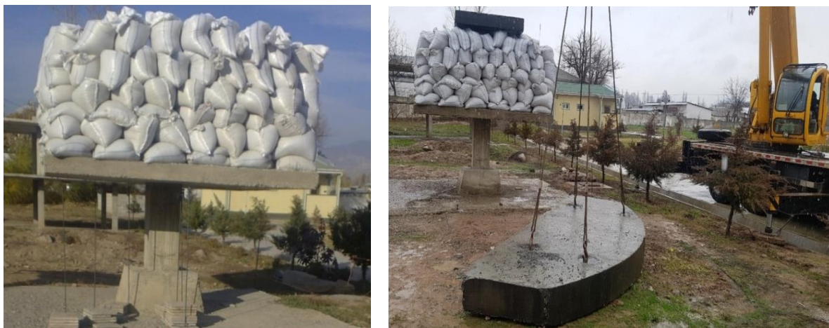
Расми 8. Маржилаи навбати боргузорӣ, ки 25,2 \text{ кН/м}^2 – ро ташиқ намуд ва аз тарафи рост санҷиши банди пайвасти плита бо сутуни синҷи биболор ба таъсири динамикӣ. Ба болои бори статикӣ плита бо вазни 3200 \text{ кг} гузошта шудааст ва ба болои он бори динамикӣ – плита бо массаи 5640 \text{ кг} аз баландии 1...6 \text{ м} партофта мешавад
