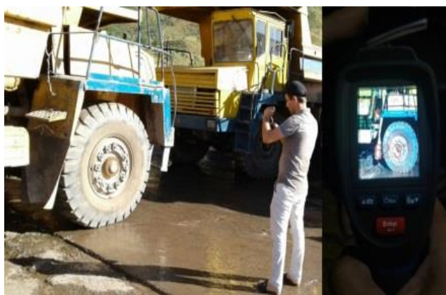
Расми 8 – Ченкунии ҳарорати шинаҳо: а – бо пирометр; б – бо тепловизор
