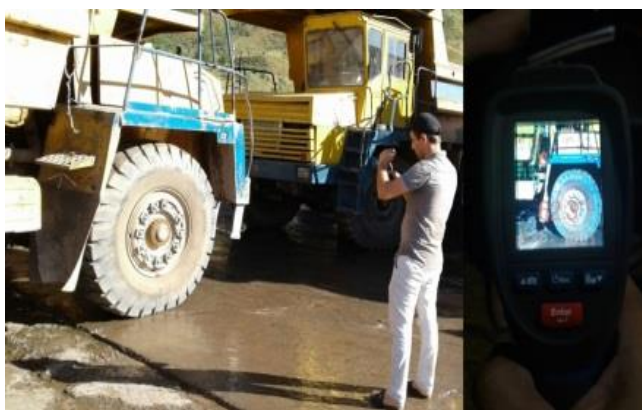
Рисунок 8 – Измерение температуры шины: а – пирометром; б - тепловизором
