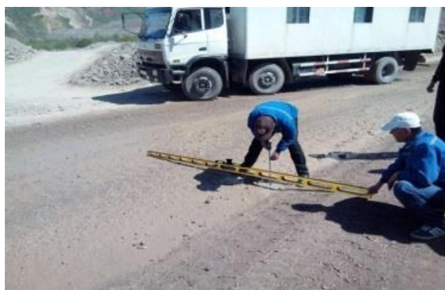
Рисунок 9 – Измерение неровности дорожного полотна: а - 3-х метровой рейкой; б – нивелиром
