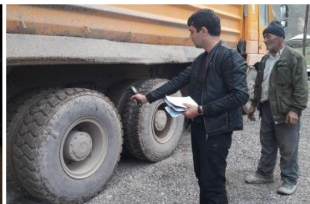
Расми 8 – Ченкунии ҳарорати шинаҳо: а – бо пирометр; б – бо тепловизор
