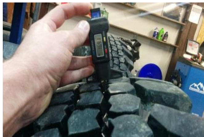
Расми 7 – Ченкунии хурдашавии шина бо умқсанчаки микрометрӣ
