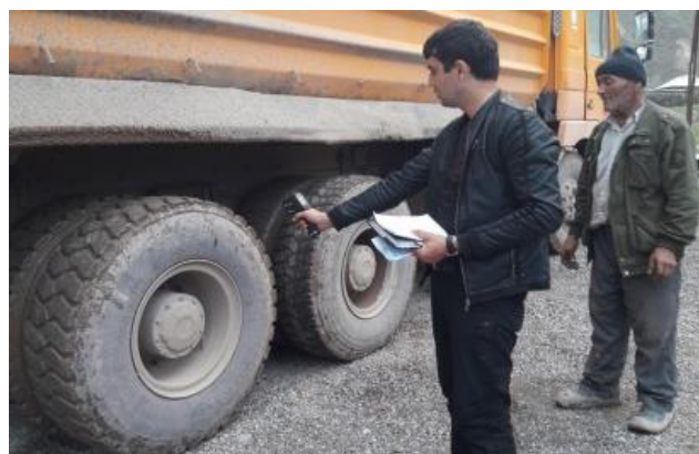
Рисунок 8 – Измерение температуры шины: а – пирометром; б - тепловизором
