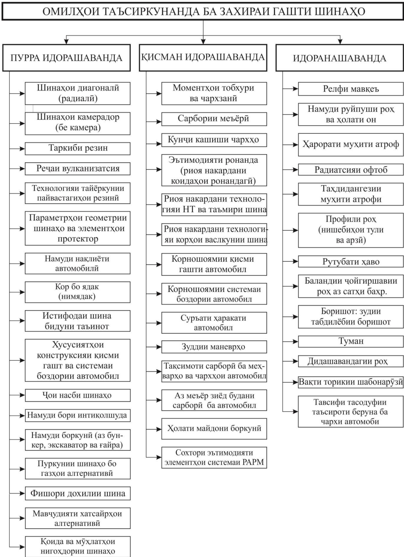
Расми 2 - Таснифи омилҳои таъсиррасон ба захираи гашти шинаҳои автомобилҳои боркаши дар қарғарҳои қўҳӣ истифодашаванда аз рӯи нишонаҳои идорашавандагӣ
