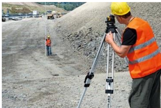
Рисунок 9 – Измерение неровности дорожного полотна: а - 3-х метровой рейкой; б – нивелиром
