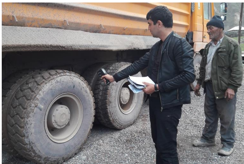
Рисунок 3.6 – Процесс измерения температуры ШГА с использованием оптического тепловизора
