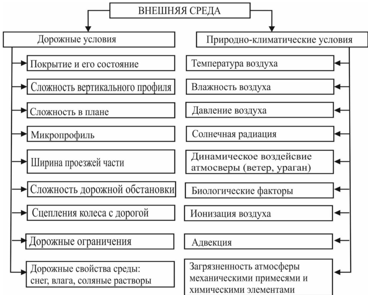
Рисунок 1.1 – Факторы внешней среды, формирующие дорожные и природно-климатические воздействия в горных условиях эксплуатации АТС [1]
