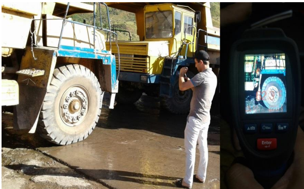
Рисунок 3.5 – Процесс измерения температуры ШГА с использованием пирометра DT–9862
