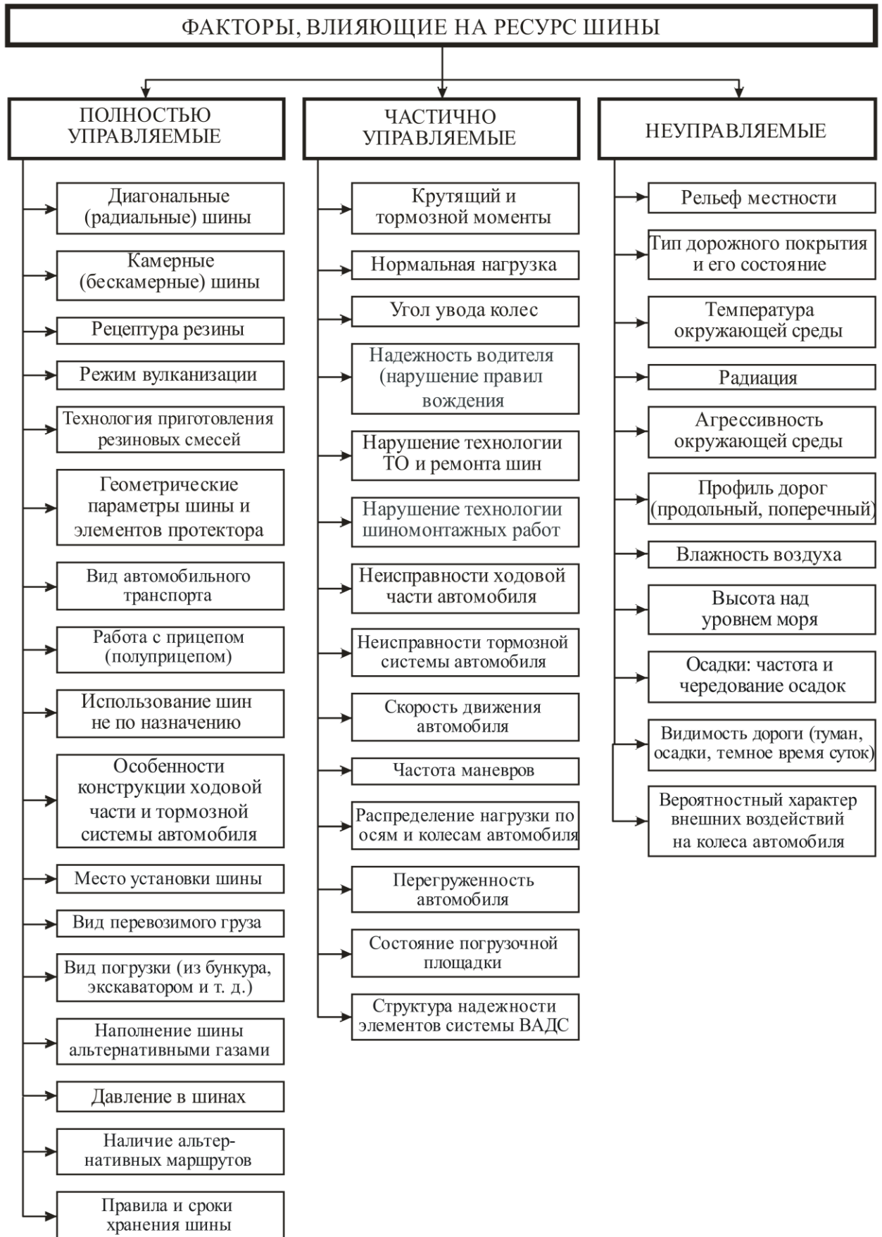
Рисунок 1.3 – Классификация факторов, влияющих на ресурс ШГА, эксплуатируемых в условиях горных карьеров по признаку управляемости
