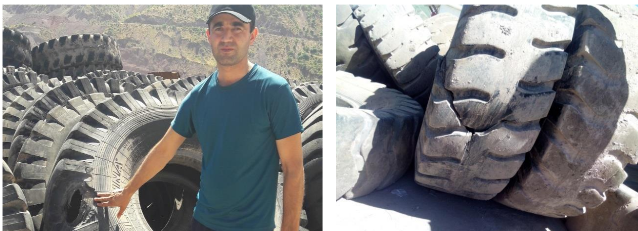
Рисунок 1.6 – Механические повреждения автомобильной шины на горной карьерной дороге, засоренной дресвяными и щебенистыми обломками горных пород
