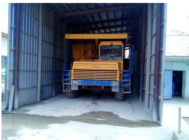
Рисунок 3.7 – Определение радиальной нагрузки на колесо грузового автомобиля взвешиванием на стационарных автомобильных весах платформенного типа
