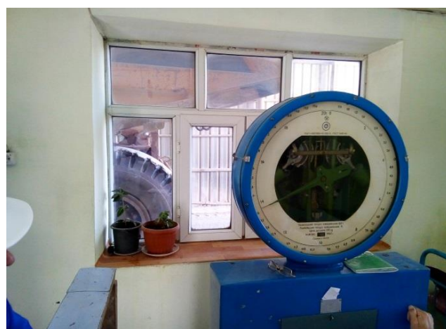
Рисунок 3.7 – Определение радиальной нагрузки на колесо грузового автомобиля взвешиванием на стационарных автомобильных весах платформенного типа
