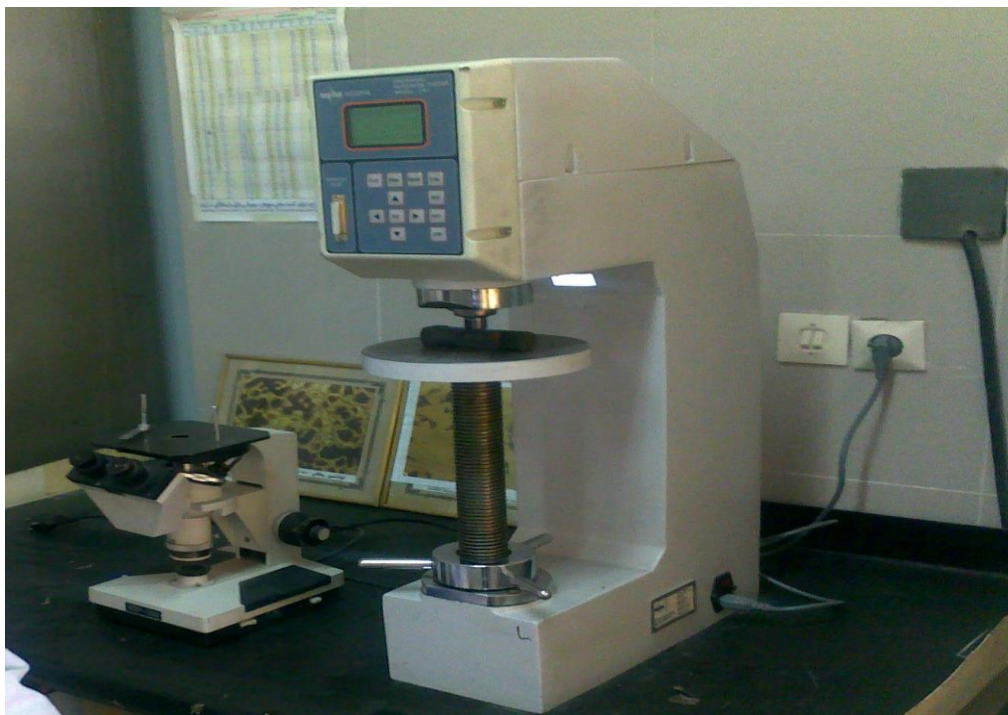
Рисунок 2.3 – Твердомер Couprall (Иран)
