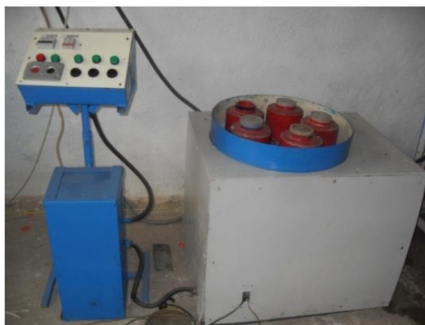
Рис. 1.7. Станок планетарно-центробежный для обработки самоцветных камней
