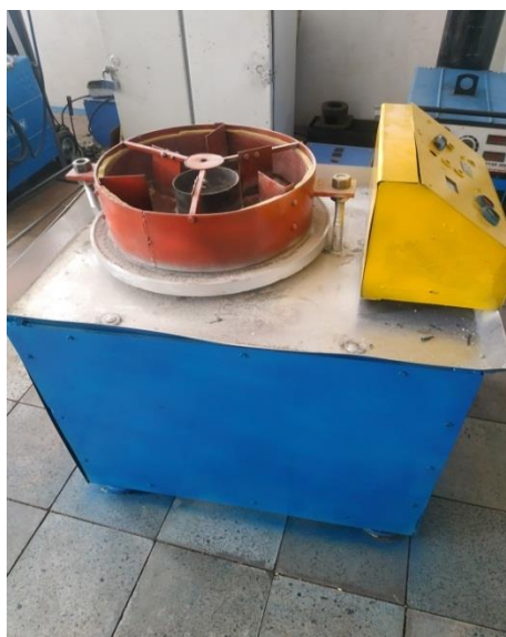
Рисунок 2.16. Станок для формообразования шариков из самоцветных камней монтированы в стержнях 8 , прикреплённых к верхнему торцу барабана. Барабан 5 посредством ушек и стоек 7 и болтов 9 прикрепляется к станине станка.
