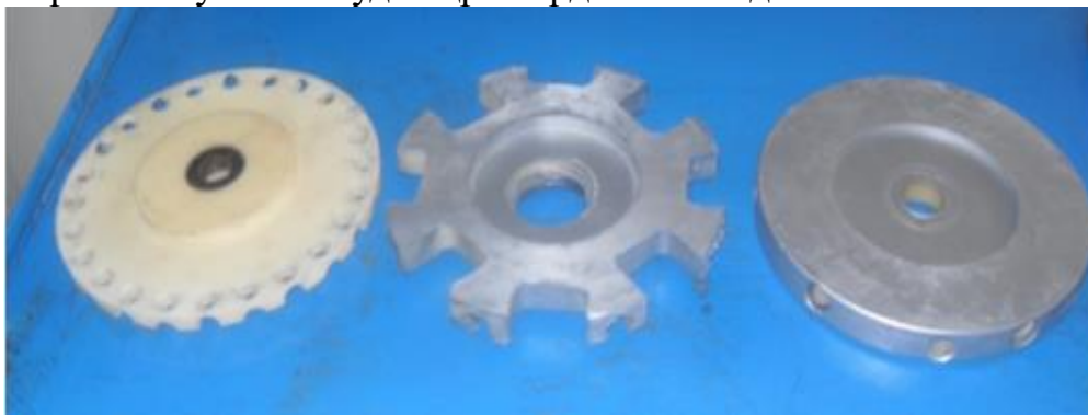
Расми 6. Асбобҳои кассетавӣ барои коркарди марказгурези абразивии саққоҳо
