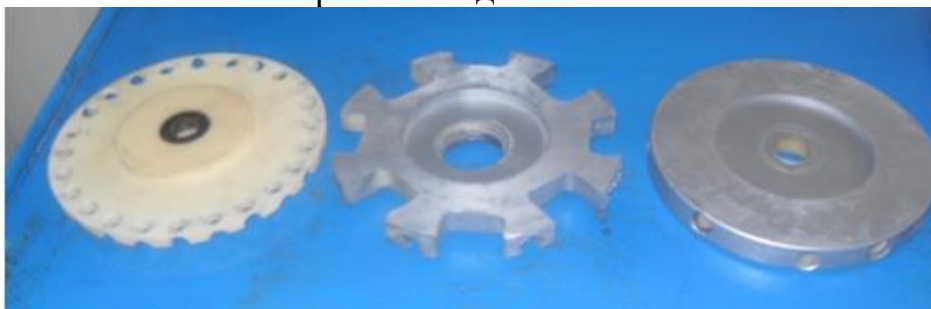
Рис.6. Кассетные инструменты для центробежной абразивной обработки шариков
