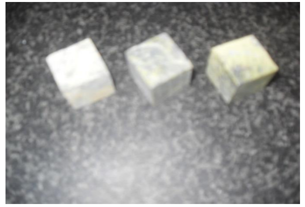
Рис.П7. Образец камня после резки (заготовки для получения шариков)
