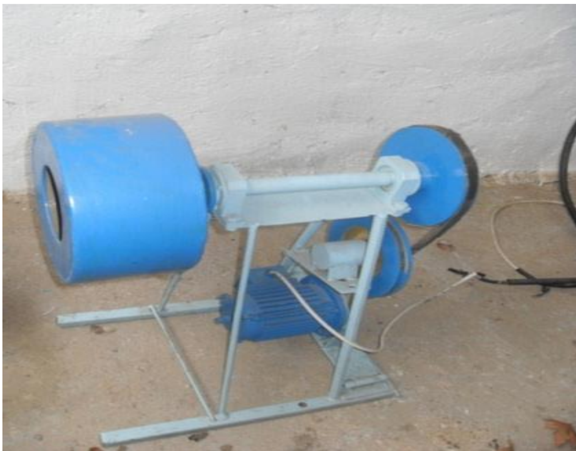
Рис.П1. Галтовочный барабан с горизонтальной осью вращения
