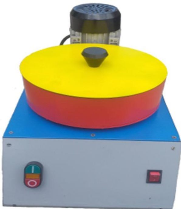
Рис.П4. Станок для центробежной абразивной обработки
