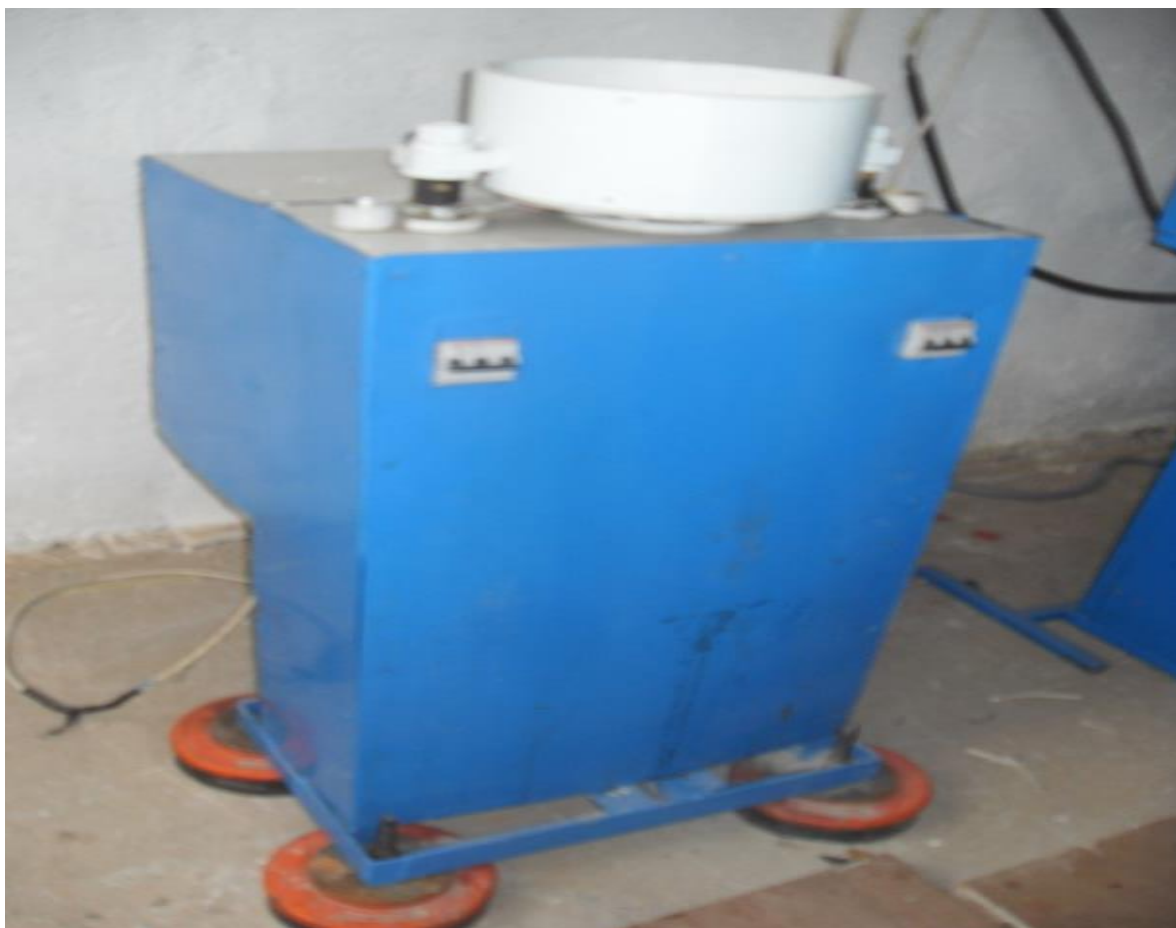
Рис.П3. Станок для центробежной абразивной галтовки
