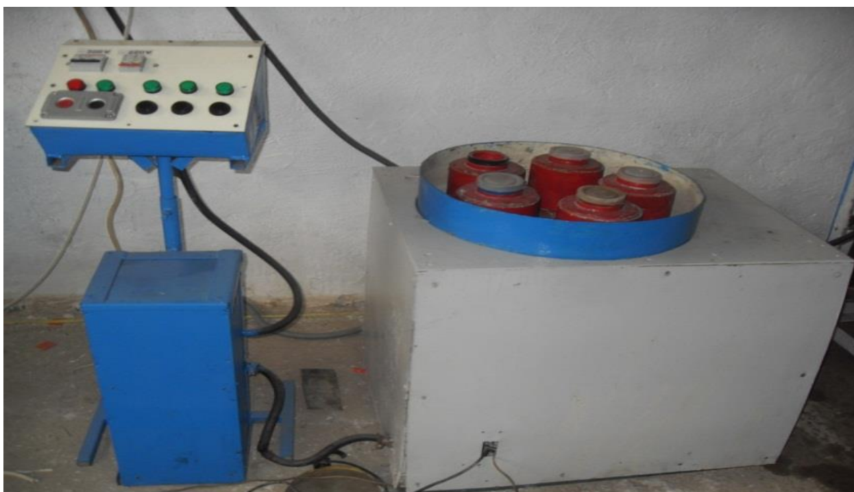
Рис.П2. Станок для планетарно-центробежной обработки
