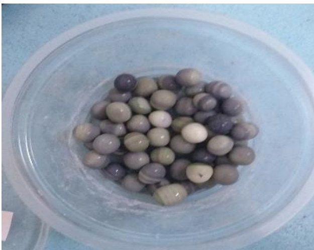
Рис.П8. Исходное сырье и его формообразование в виде шариков
