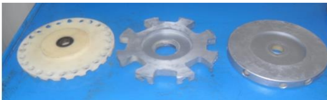
Рис.4.17. Кассетные инструменты для центробежной абразивной обработки шариков
