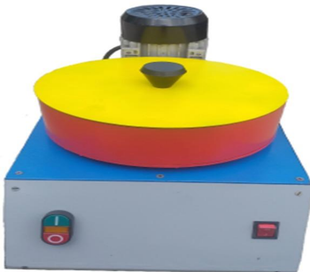
Рис. 2.8. Устройство для многодисковой центробежной абразивной обработки полудрагоценных и поделочных камней
