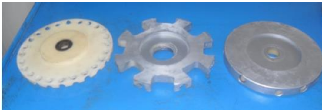
Рис.4.13. Кассетные инструменты для центробежной абразивной обработки шариков
