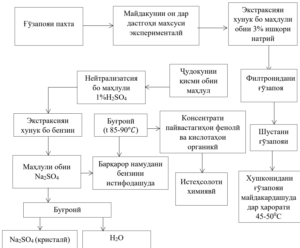
Расми 2 - Технологияи коркардшудаи тоза намудани таркиби ғўзапояи пахта аз пайвастиҳои дорои хосияти кислотагидошта
