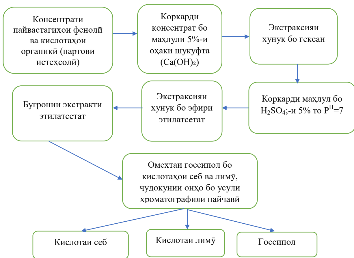
Расми 4 - Хатти технологияи технологияи ҳосил намудани госсипол дар асоси партови истеҳсолоти биоэтанол
