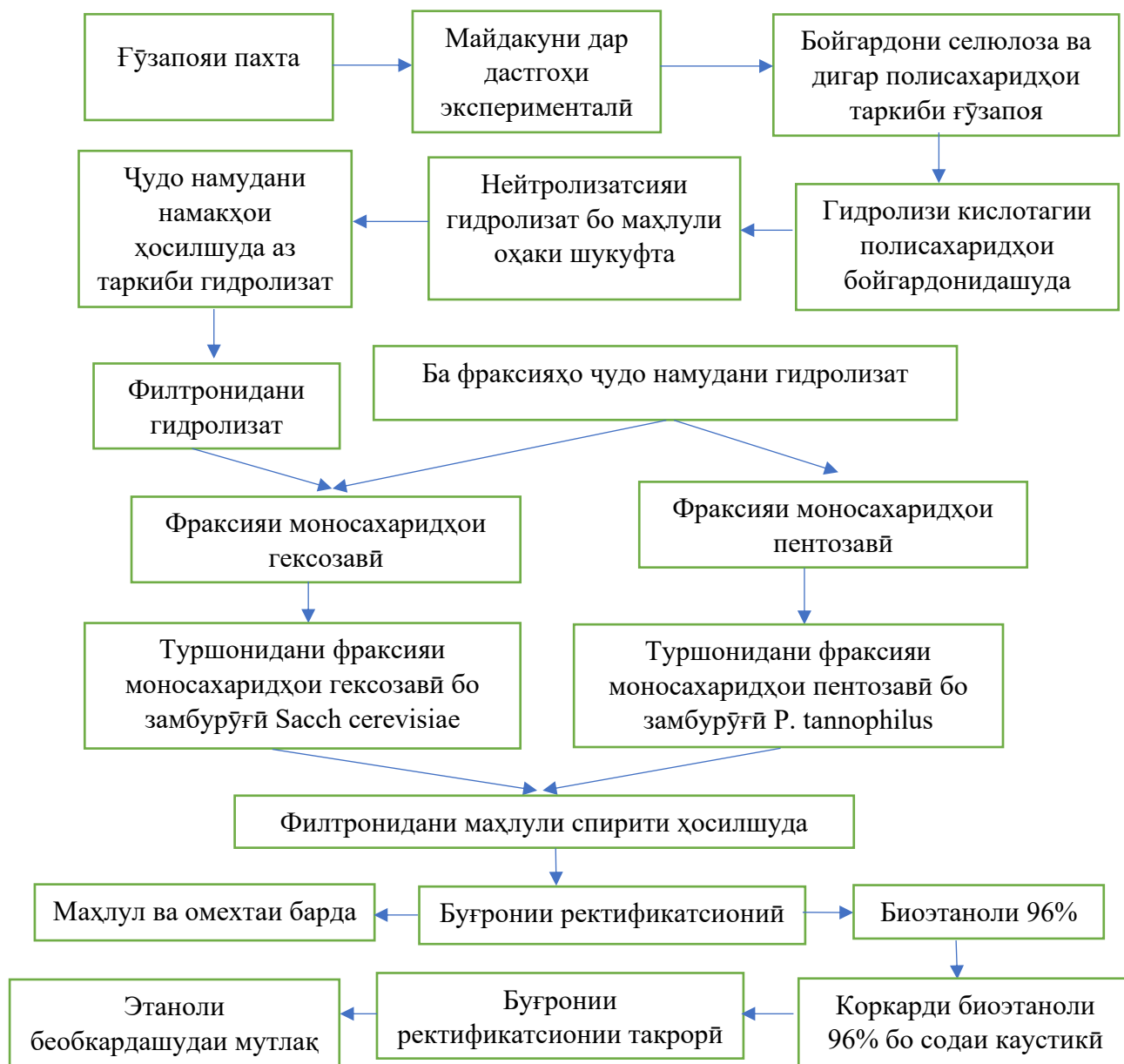
Расми 5 - Ҳатти технологияи ҳосил намудани сӯзишвории биологӣ биоэтанол дар асоси ғўзапояи пахта
