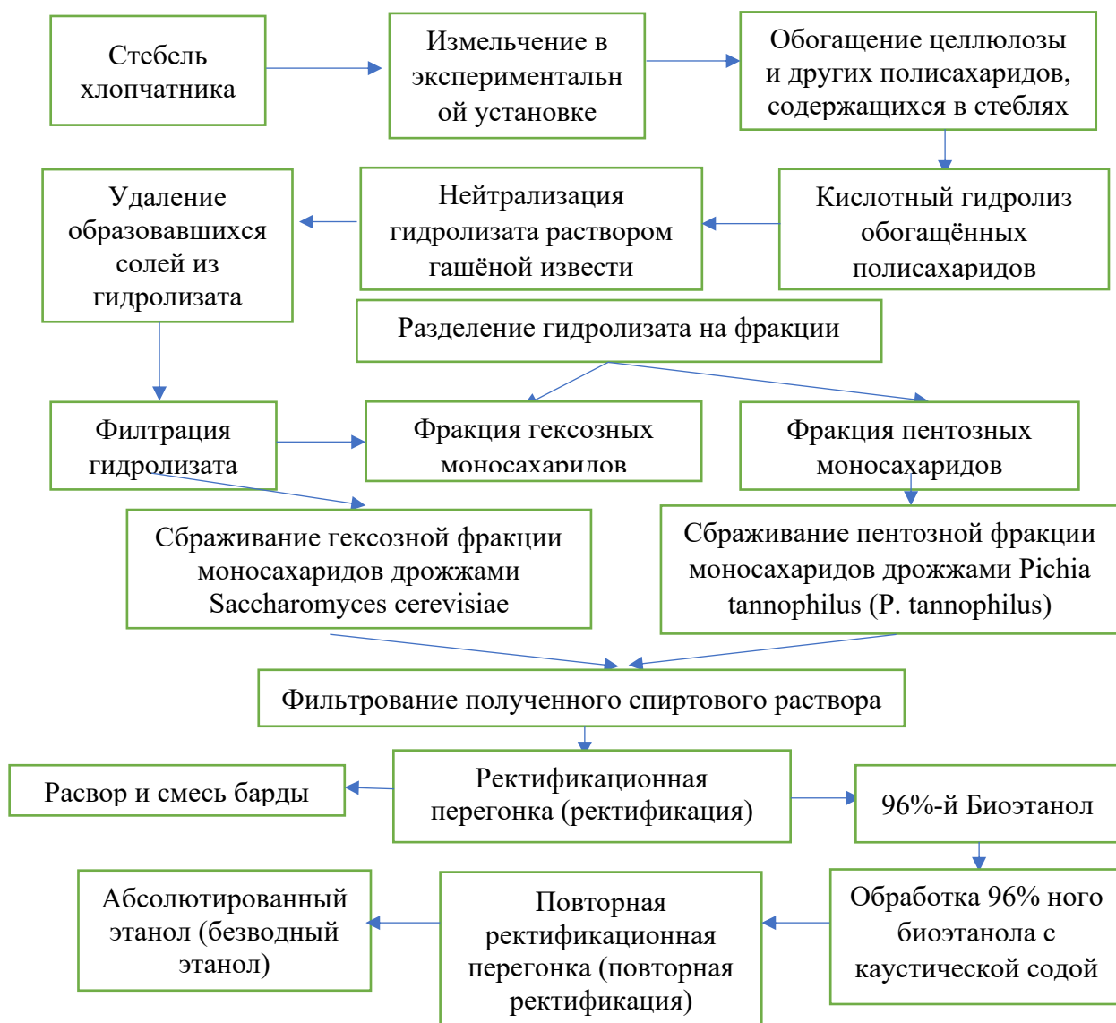
Рисунок 5 - Технологическая линия получения биотопливного биоэтанола на основе стеблей хлопчатника
