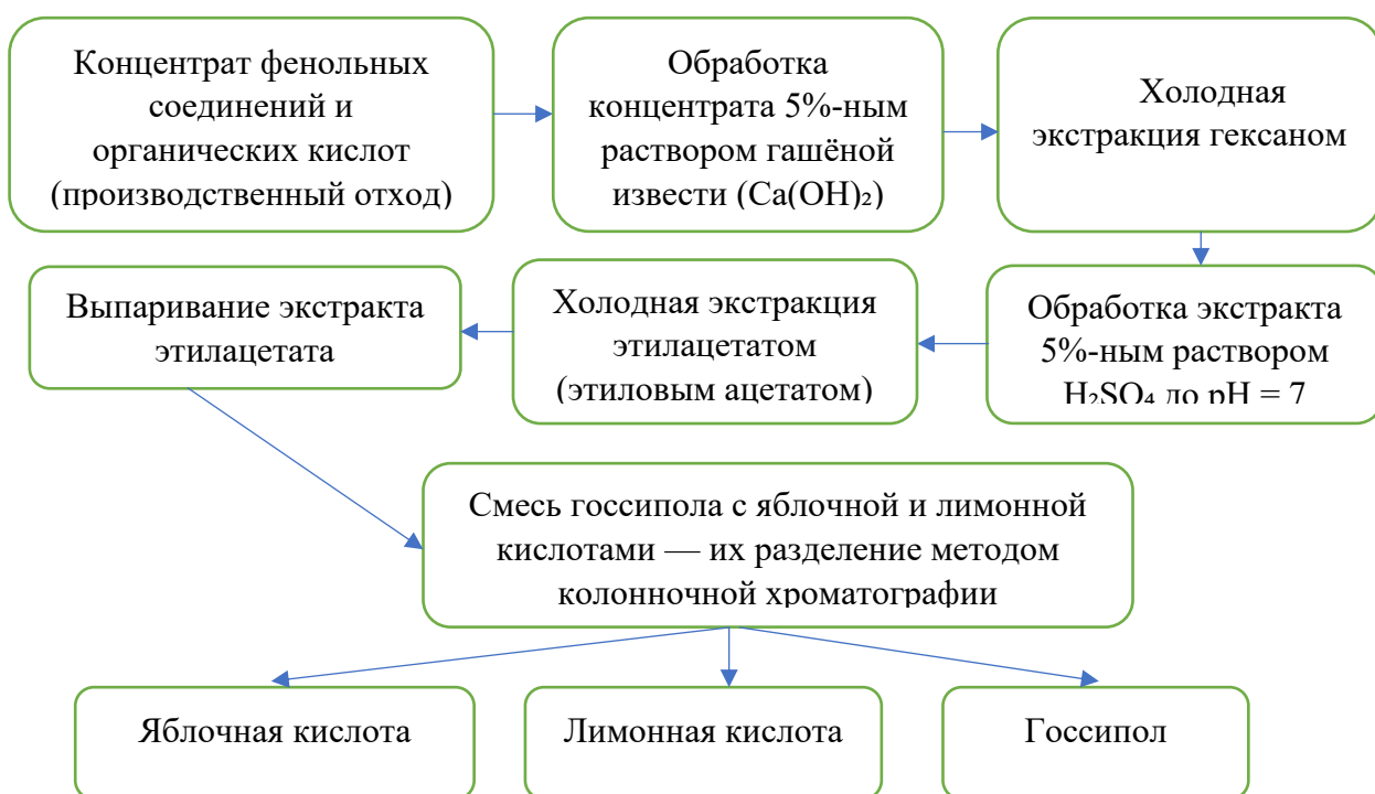
Рисунок 4 - Технологическая линия получения госсипола на основе отходов производства биоэтанола
