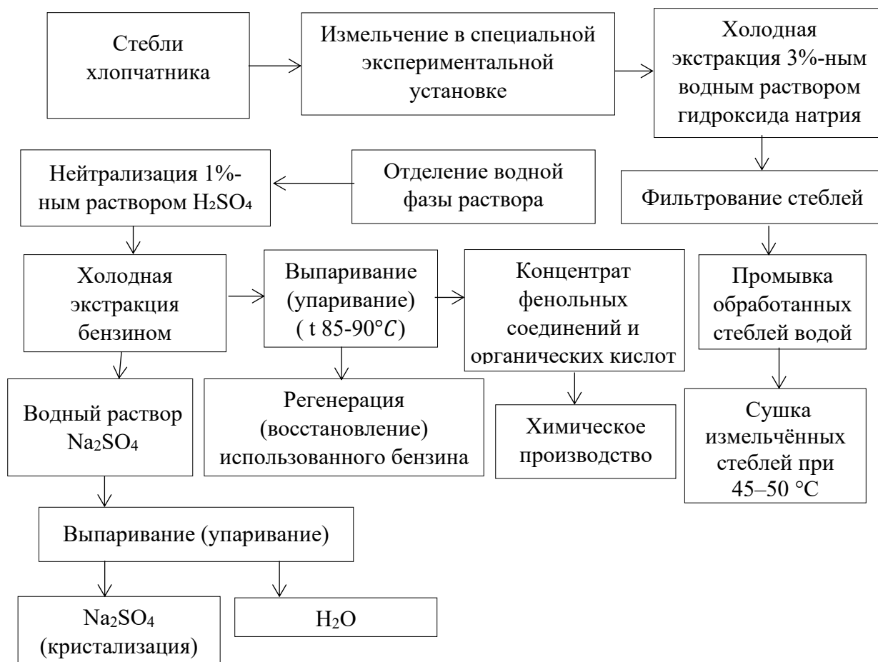
Рисунок 2 - Разработанная технология очистки стеблей хлопчатника от соединений обладающим кислотным свойством
