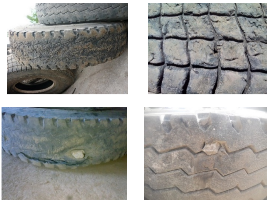
Рисунок 2.9 – Механические повреждения автомобильной шины на горной карьерной дороге, засоренной обломками горных пород
