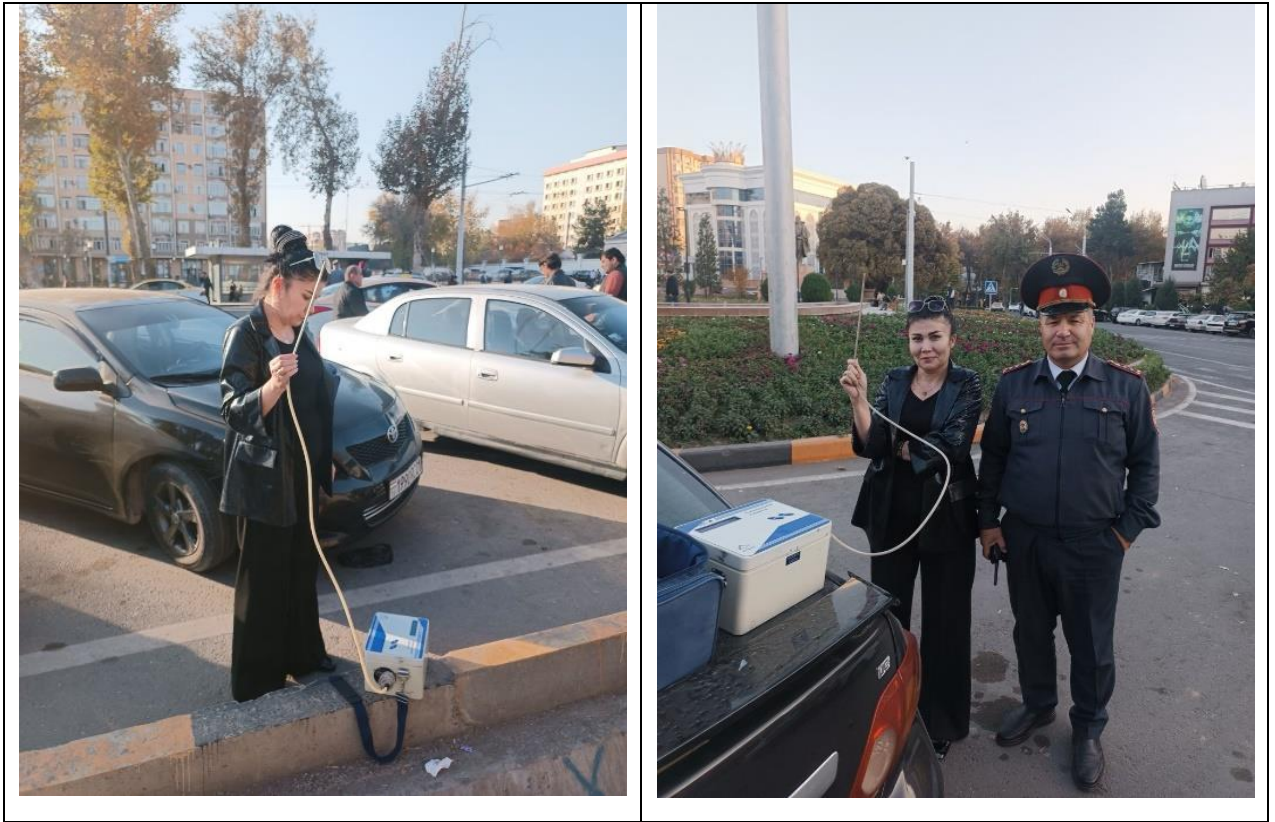
Расми 25. Андозагирии консентратсияи моддаҳои ихроҷшаванда ба ҳавои атмосфера бо истифода аз газоанализатори «ГАНК - 4».
