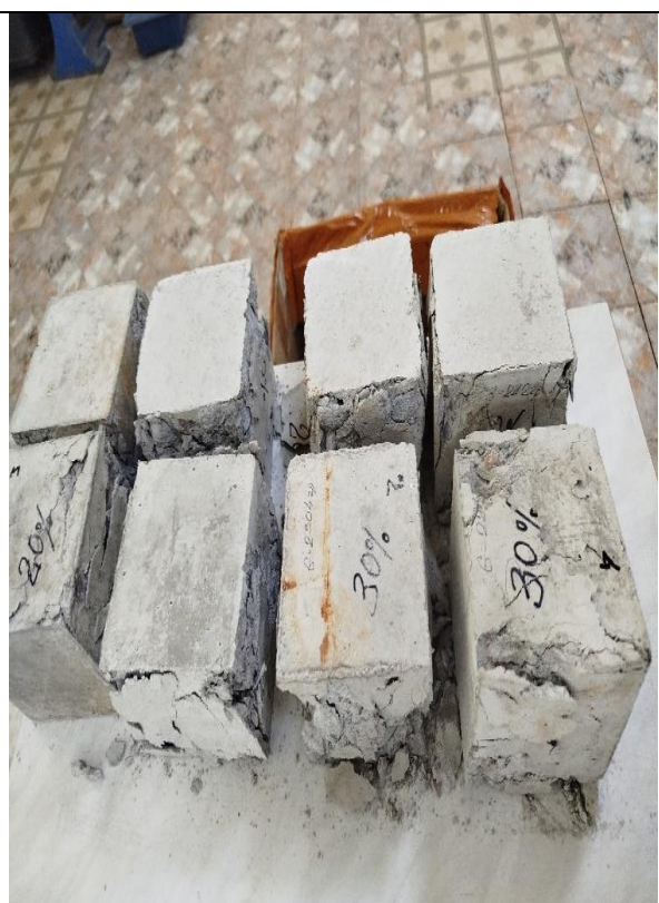
Расми 11. Блокҳои тафолаву бетонӣ пас аз озмоиши мустаҳкамӣ (дар дастгоҳи фишордиҳии WES-1000B)
