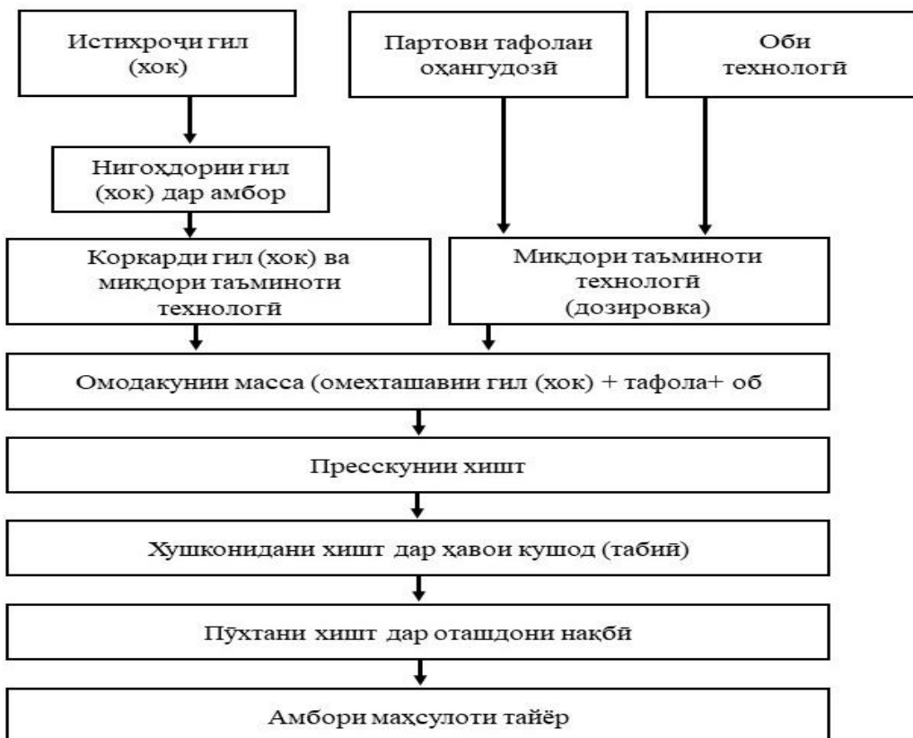
Расми 15. Нақшаи принципалии ҳатти муосиргардонидашудаи истеҳсоли хишти сафолӣ дар ҚДММ «Аква»
