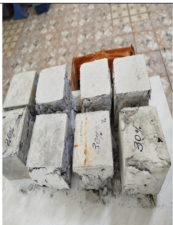
Рисунок 11. Цементные блоки после испытания на прочность (прессе WES-1000B)
