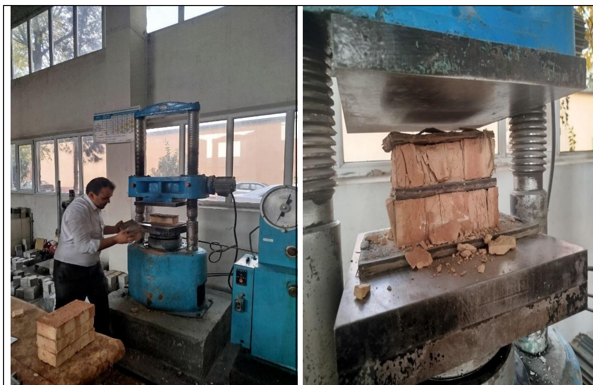
Рисунок 1. Образцы керамического кирпича до и после раздавливания
