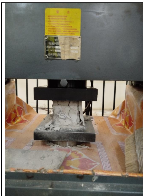
Расми 10. Озмоиши мустаҳкамӣ ба фишор дар дастгоҳи фишордиҳии WES-1000B
