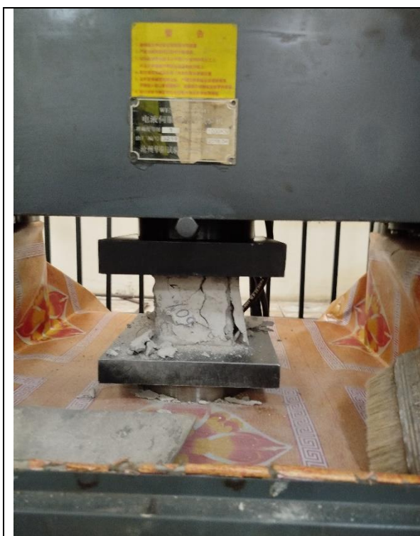
Рисунок 10. Испытание на прочность при раздавливании на прессе WES-1000B
