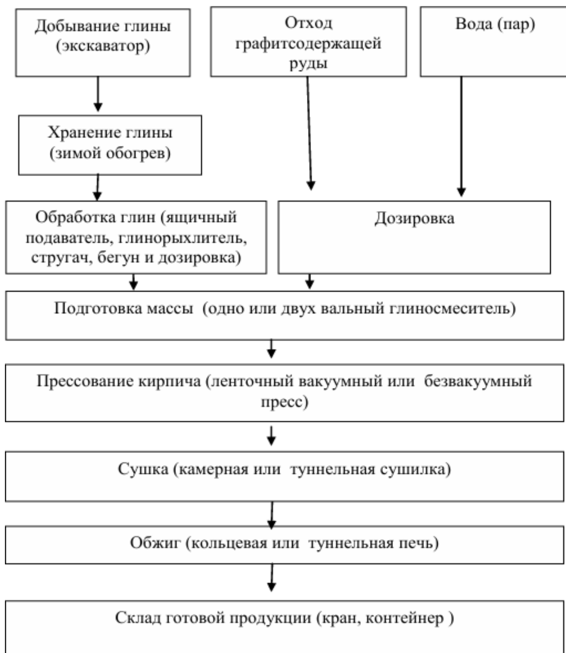
Рисунок 15. Принципиальная схема модернизированной линии производства строительного керамического кирпича на ООО «Аква»
