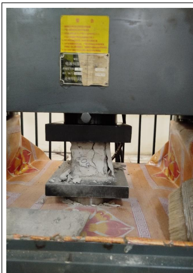
Расми 3.18. Озмоиши мустаҳкамӣ ба фишор дар дастгоҳи фишордиҳии WES-1000B
