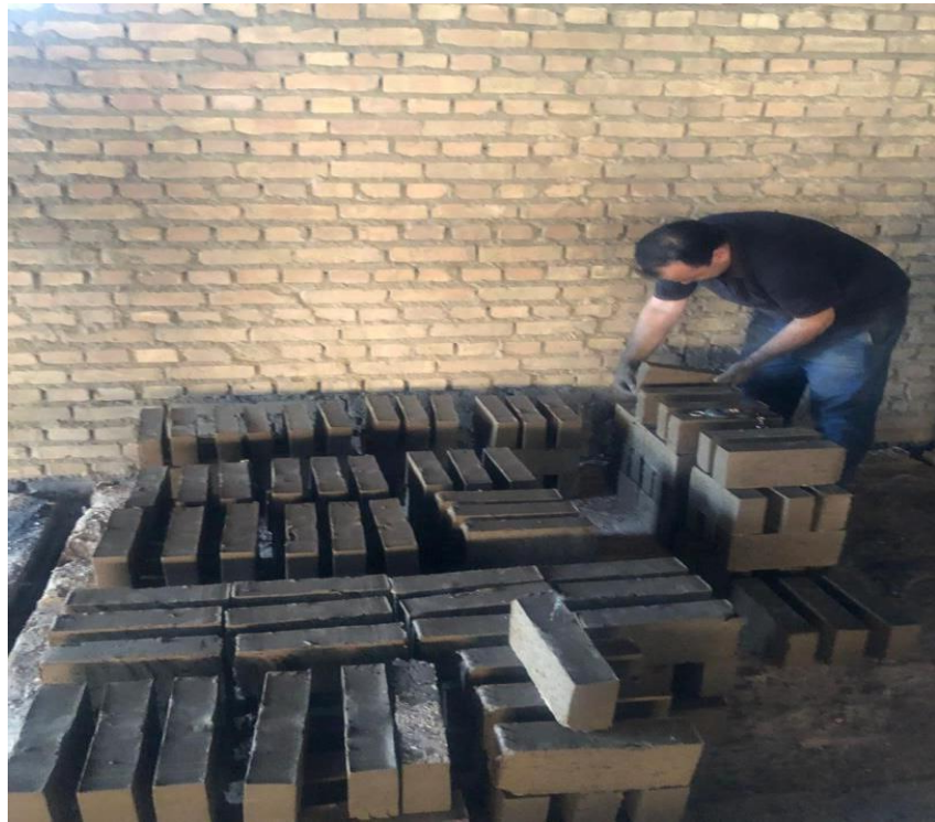
Расми 3.1. Намунаҳои таҷрибавии хишти сафолӣ пас аз 7 шабонарӯзи ( \bar{t} = 27\text{ }^{\circ}\text{C} ) сахтшавӣ.
