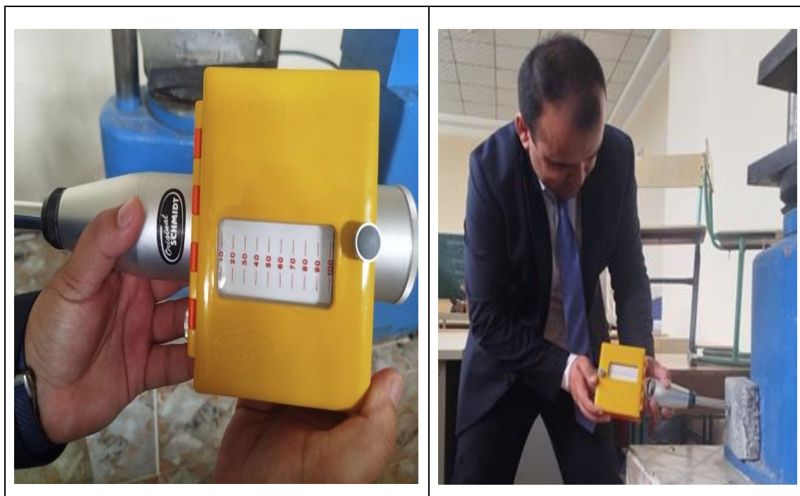
Расми 3.22. Озмоиши намунаҳои тахтасангҳои пиёдароҳ барои муайян намудани мустаҳкамӣ
