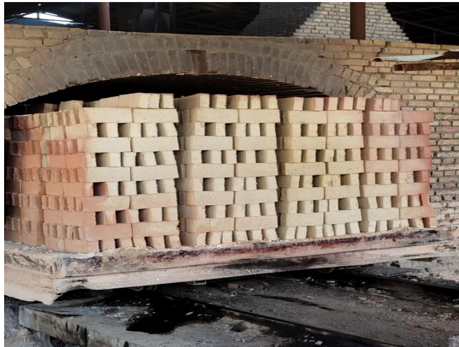
Расми 3.2. Намунаҳои таҷрибавии хишти сафолӣ пас аз гузаронидани раванди пухтан ҳангоми \bar{t} = 900\text{ }^{\circ}\text{C} .
