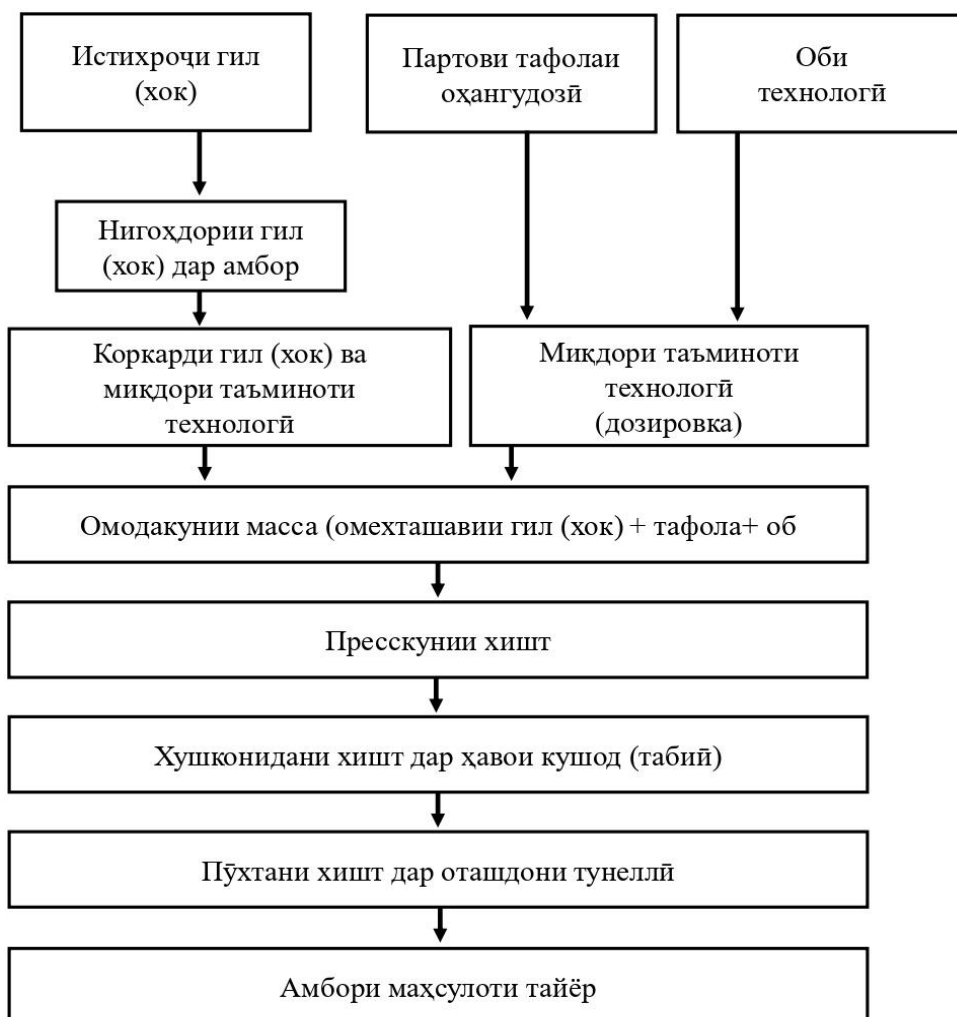
Расми 4.2. Нақшаи принципалии хаттии муосиргардонидашудаи истеҳсоли хишти сафолӣ дар ҶДММ «Аква»
