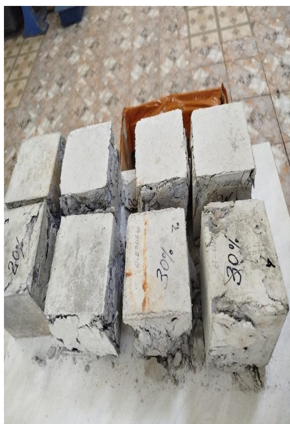
Расми 3.19. Блокҳои тафолаву сементӣ пас аз озмоиши мустаҳкамӣ (дар дастгоҳи фишордиҳии WES-1000B)
