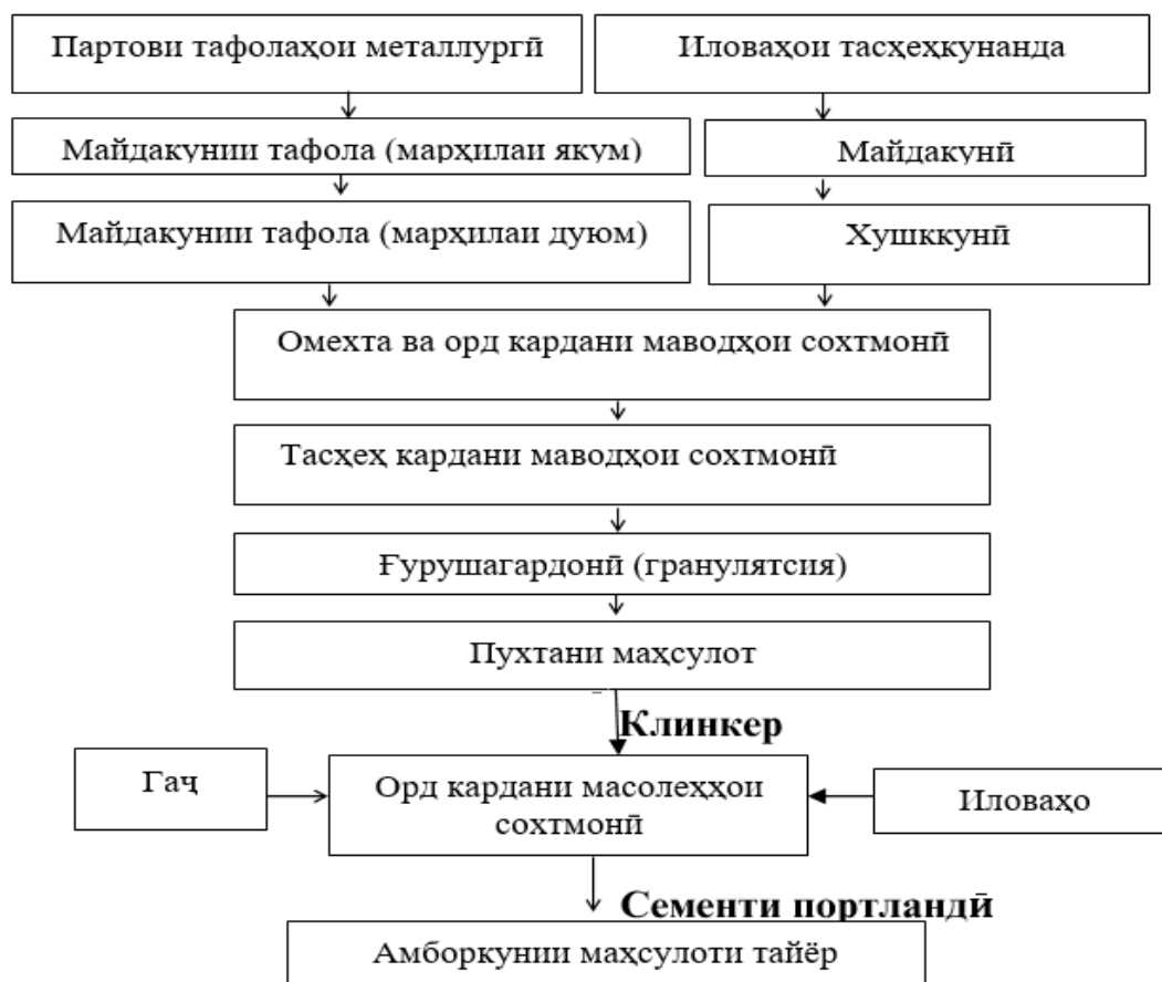
Расми 1.7. Нақшаи технологии истеҳсоли сементи портландӣ дар асоси ашёи хоми техногенӣ (тафола, хокистари ангишт)
