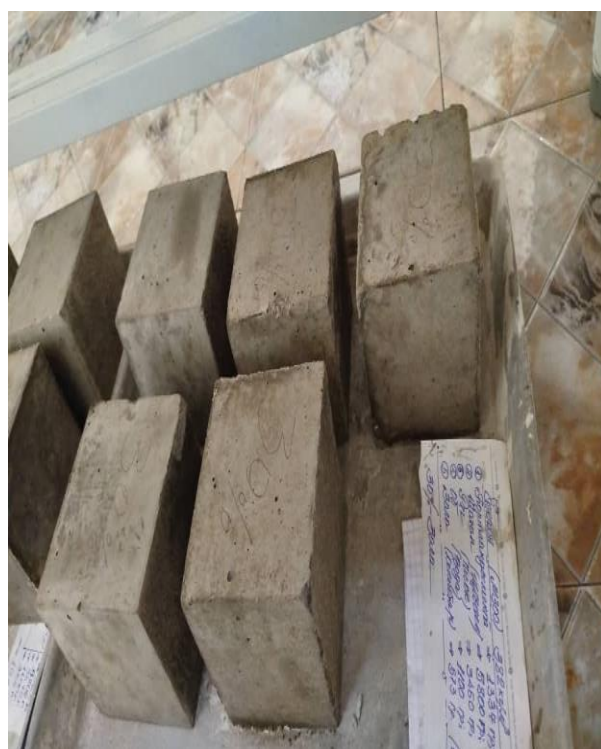
Расми 3.17. Намунаҳое, ки пас аз як шабонарӯз нигоҳ доштан аз қолабҳо берун оварда шудаанд
