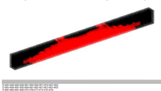
Рисунок 26. Картина распределения трещин модельной железобетонной балки
