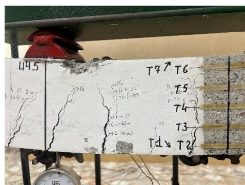
Разрушение сжатой зоны бетона
