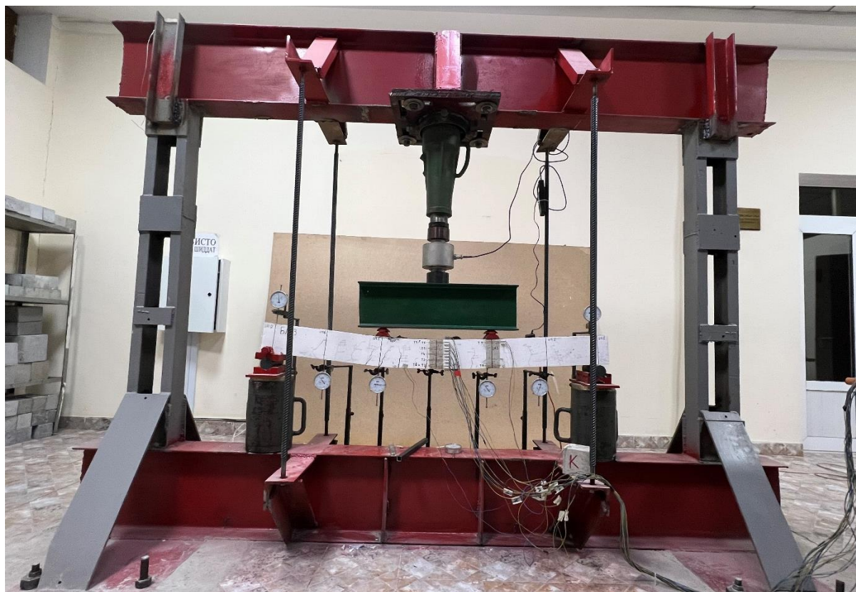
Модельная железобетонная балка БМ-3 в процессе проведения испытаний
