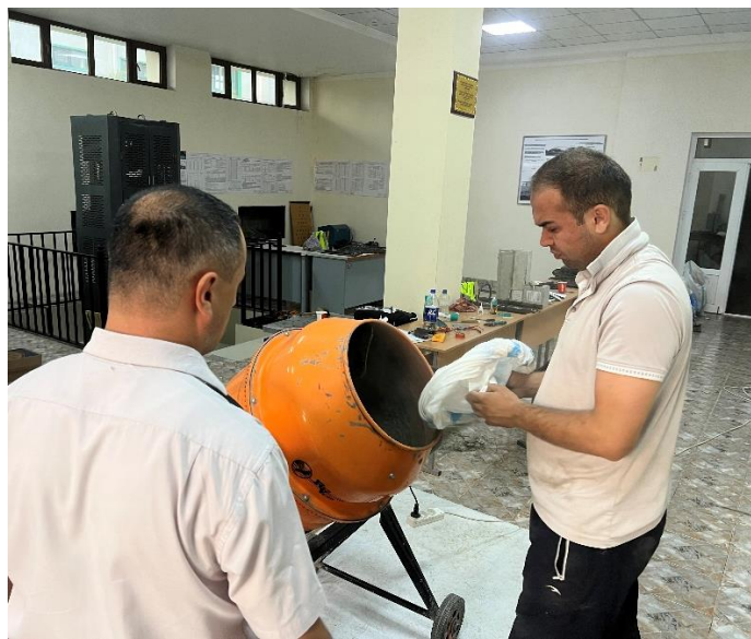
Рисунок 3.12. Подготовка и подбор фракций бетонной смеси для изготовления моделей железобетонных балок
