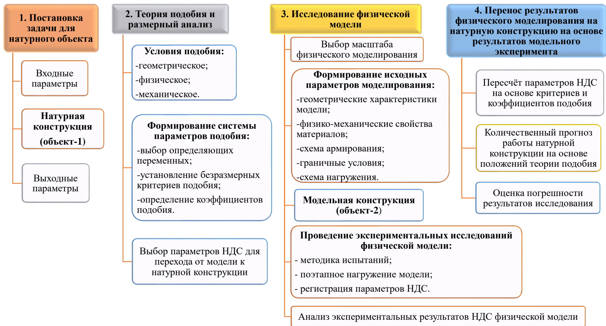
Рисунок 1.2. Схема физического моделирования железобетонных конструкций на основе теории подобия
