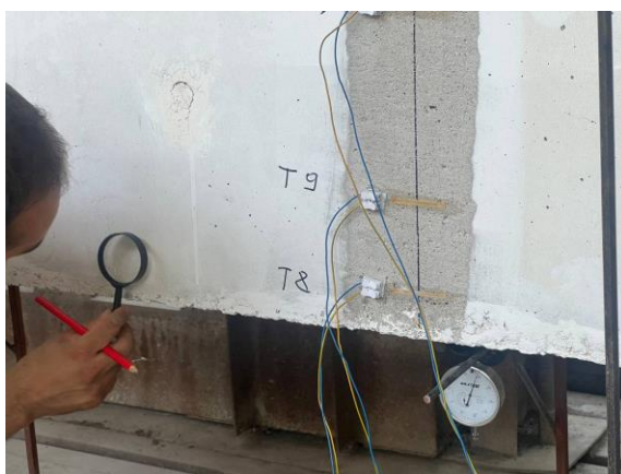
Процесс наблюдения конструкции во время выдержки под нагрузкой
