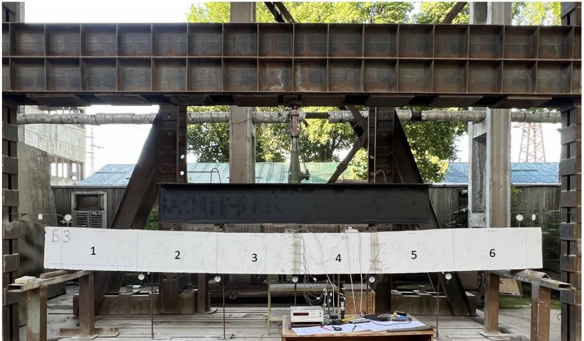
Натурная железобетонная балка БМ-3 в процессе испытания с обозначением разбивочных зон
