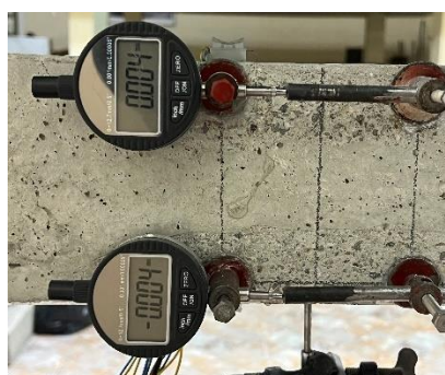
Процесс измерения деформаций бетона
