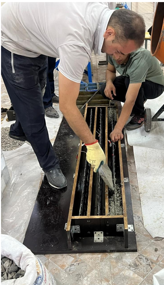
Рисунок 3.13. Модели железобетонных балок и соответствующие контрольные образцы в состоянии после бетонирования
