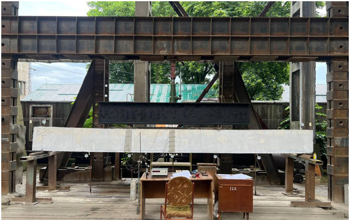
Натурная железобетонная балка БМ–2 в процессе испытания
