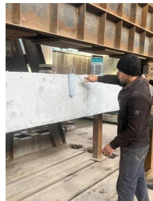
Процесс подготовки натурной железобетонной балки БМ–1 к испытанию
