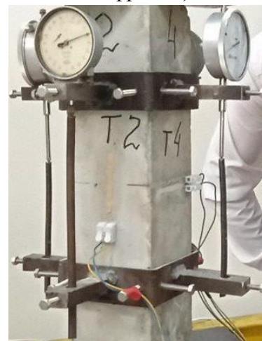
5,6 – механический измеритель деформации с ценой деления 0.001мм и 0.01мм.
