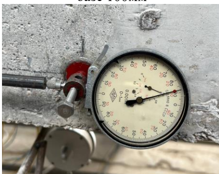
Измеритель деформаций часового типа ц.д. 0.001мм
