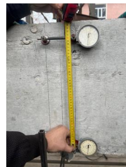
Измерение деформаций бетона на базе 100 мм
