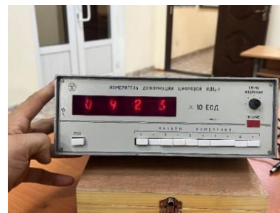
8 – ИДЦ-1 (измеритель деформаций цифровой)
