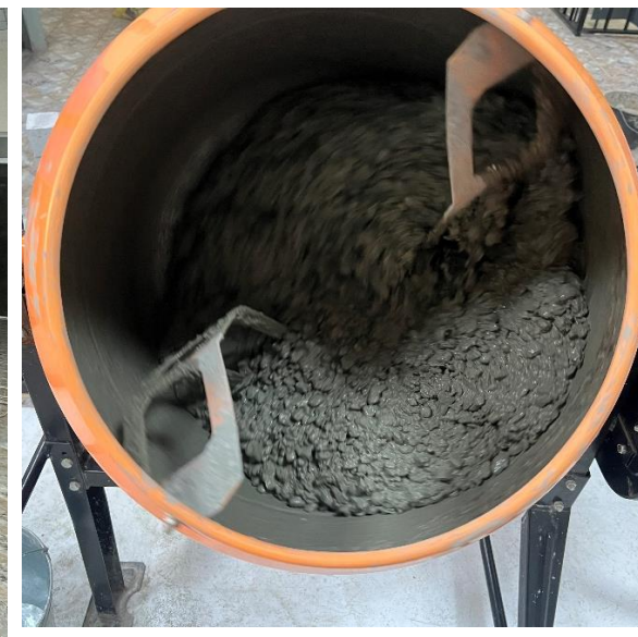
Рисунок 3.12. Подготовка и подбор фракций бетонной смеси для изготовления моделей железобетонных балок
