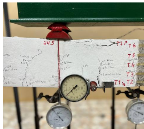
Разрушение сжатой зоны бетона
