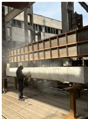
Процесс подготовки натурной железобетонной балки БМ–1 к испытанию
