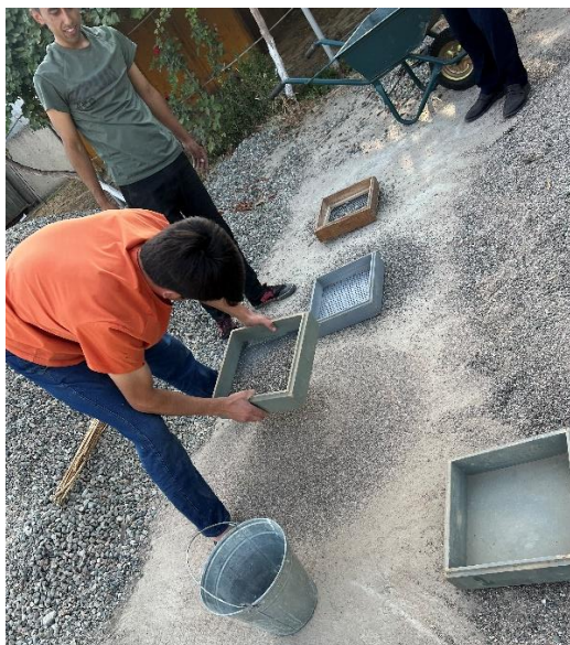
Рисунок 3.12. Подготовка и подбор фракций бетонной смеси для изготовления моделей железобетонных балок
