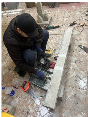
Процесс подготовки модели железобетонной балки БМ-3 к испытаниям
