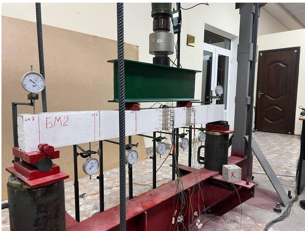
Модельная железобетонная балка БМ-2 в процессе проведения испытаний
