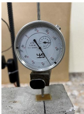
Процесс подготовки модели железобетонной балки БМ-3 к испытаниям
