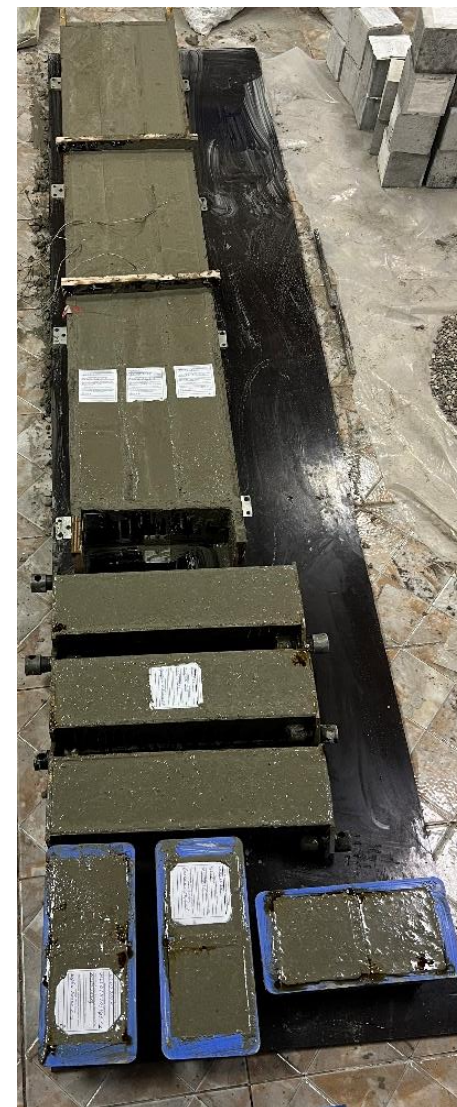
Рисунок 3.13. Модели железобетонных балок и соответствующие контрольные образцы в состоянии после бетонирования
