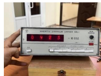
8 – ИДЦ-1 (измеритель деформаций цифровой)
