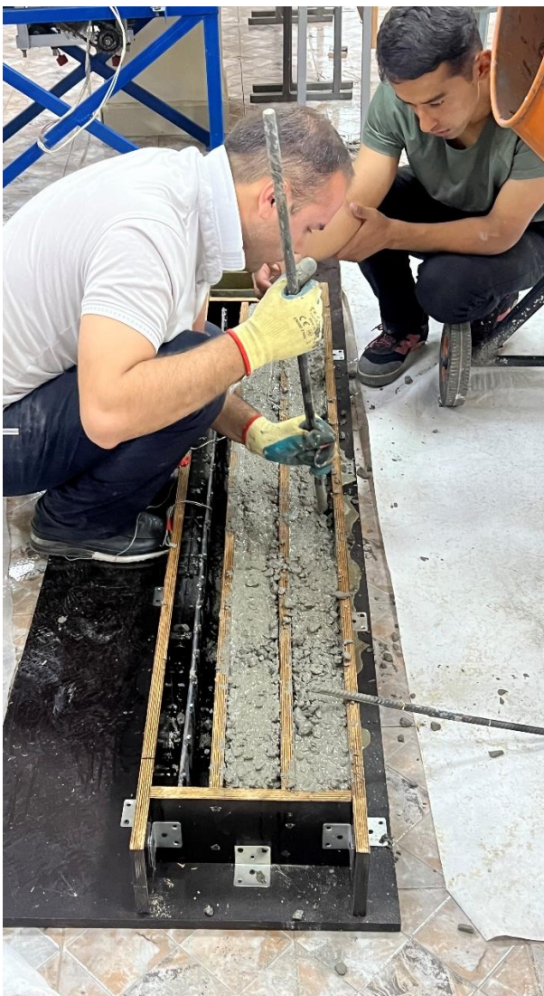
Рисунок 3.13. Модели железобетонных балок и соответствующие контрольные образцы в состоянии после бетонирования
