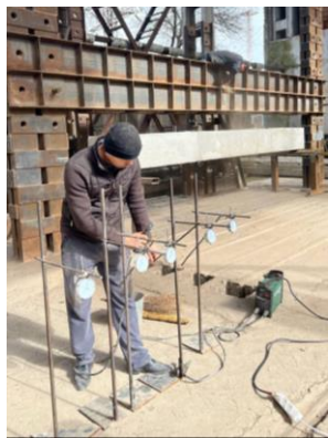
Процесс подготовки натурной железобетонной балки БМ–1 к испытанию
