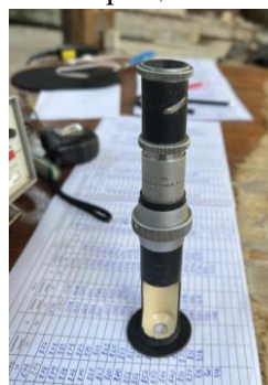
Микроскоп Бринели МПБ ц.д. 0.1мм
