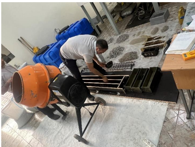
Рисунок 3.11. Этап подготовки опалубки и монтажа арматурных каркасов
