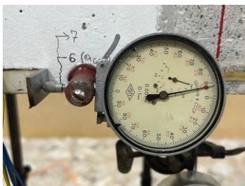
Процесс измерения ширины раскрытия трещин
