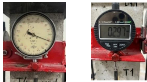
5,6 – механический и электронный измеритель деформации с ценой деления 0.001мм
