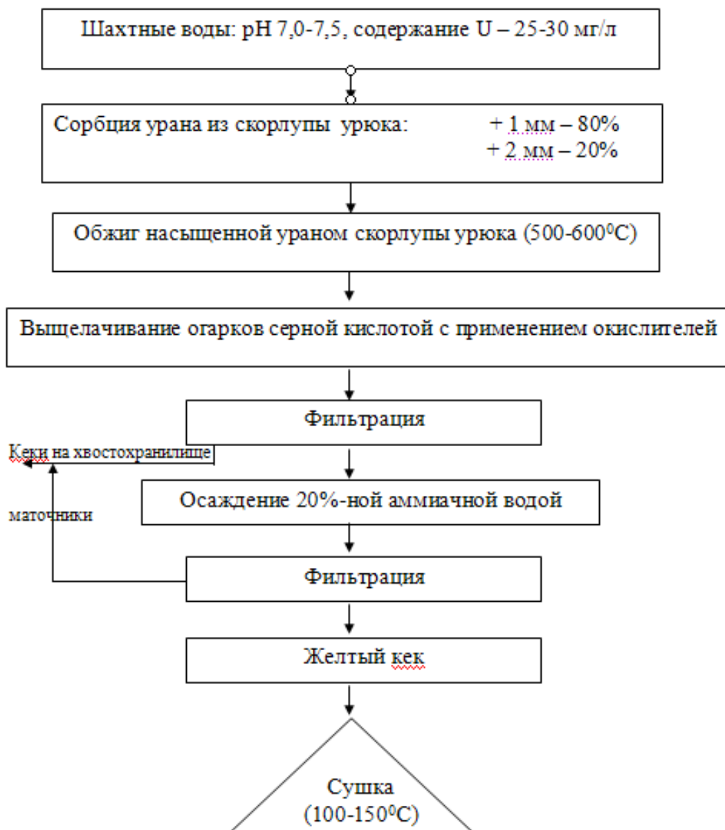
Рисунок 1.1 – Обобщённая технологическая схема для извлечения урана из ураносодержащих дренажных и шахтных вод
