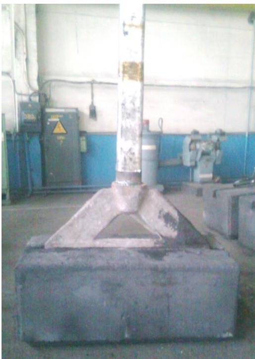
**Рисунок 2.21 - Экспериментальный анодный токоподвод в сборе**
