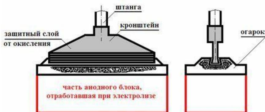
Рисунок 3.22 - Остаток анодного блока после процесса электролиза.
