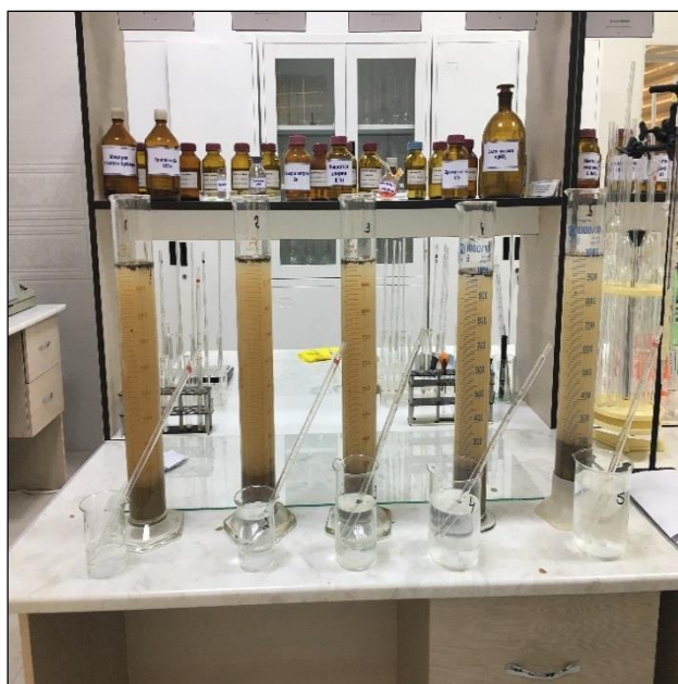
Рисунок 3.1. – Процесс осветления воды коагулянтom сульфата алюминия и отбор пробы
