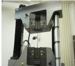
Рисунок 2.7 - Испытание арматуры на машине
