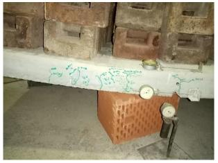
Рисунок 2.14. - Ширина раскрытия нормальных трещин в пролётных сечениях по длинной стороне плиты ОП-2 в зависимости от величины нагрузки
