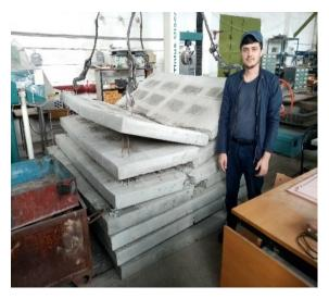
Рисунок 2.34. - Плиты после разрушения
