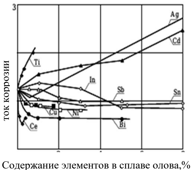
Рисунок 1.8 - Влияние легирующих элементов на ток коррозии олова в 3%-ном растворе NaCl [52,53]
