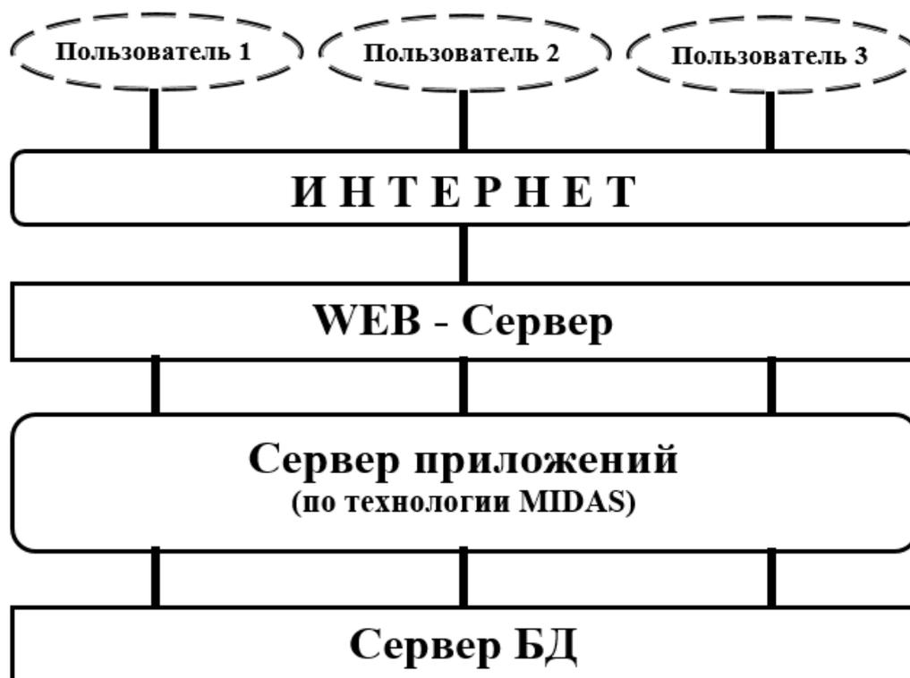
Рисунок 4.25 - Реализация пользователь-серверной архитектуры с применением технологии DataSnap
