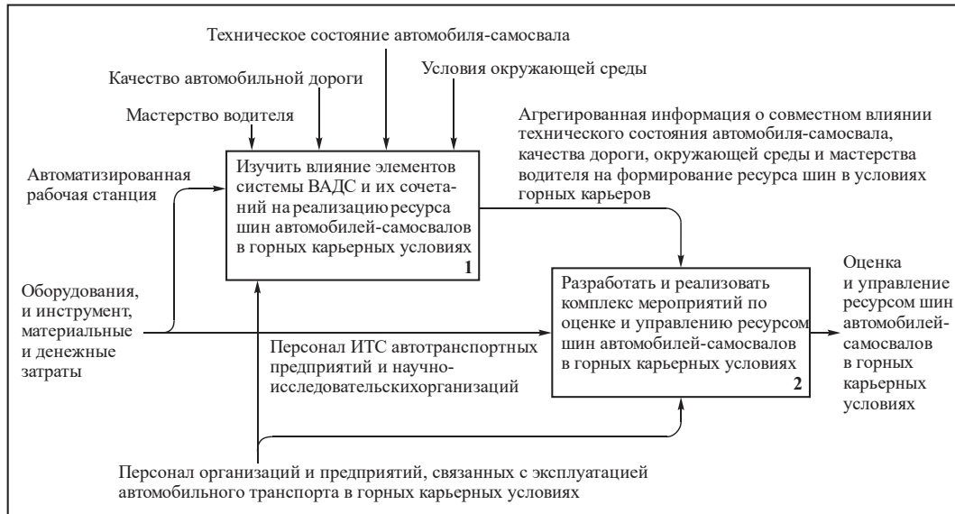
Рисунок 5 – Обеспечение адекватности оценки и эффективности системы управления ресурсом шин автосамосвалов в условиях горных карьеров
