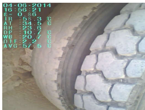
Рисунок 12 – Измерение температуры шины оптическим тепловизором
