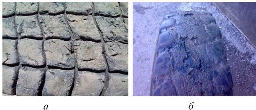
Рисунок 13 – Механизм абразивного изнашивания протекторной резины: а – направления, формы, размеры и глубины царапин и надрывов; б – крошение поверхности протектора шины
