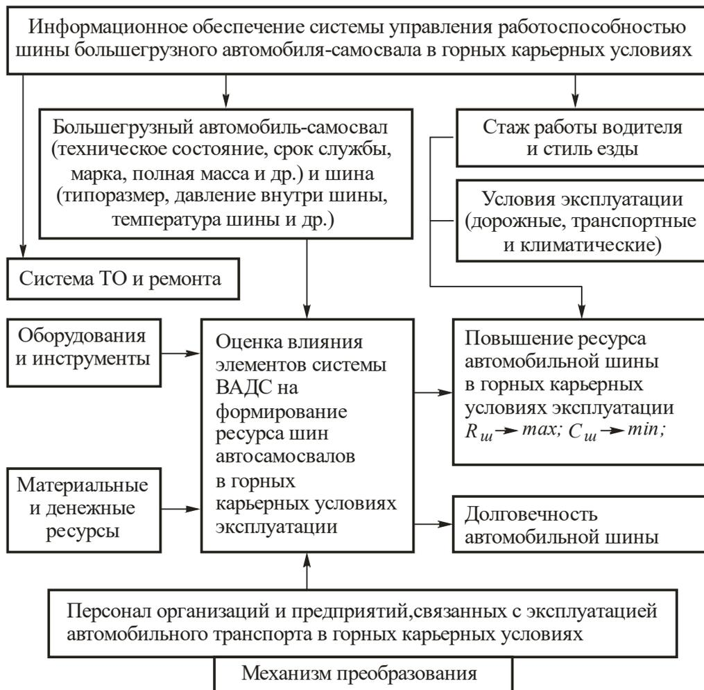
Рисунок 2.3 – Функциональный причинный блок модели «Обеспечение адекватности оценки и эффективности управления ресурсом шин автосамосвалов в условиях горных карьеров»:  $R_{ш}$  -ресурс шины;  $C_{ш}$  - эксплуатационные затраты на поддержание работоспособности шины
