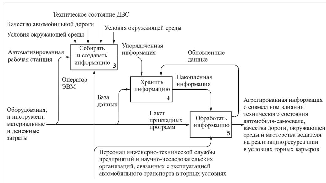
Рисунок 2.6 – Изучение совместного влияния технического состояния автосамосвала, качества дороги, окружающей среды и мастерства водителя на реализацию ресурса автомобильной шины в условиях горных карьеров
