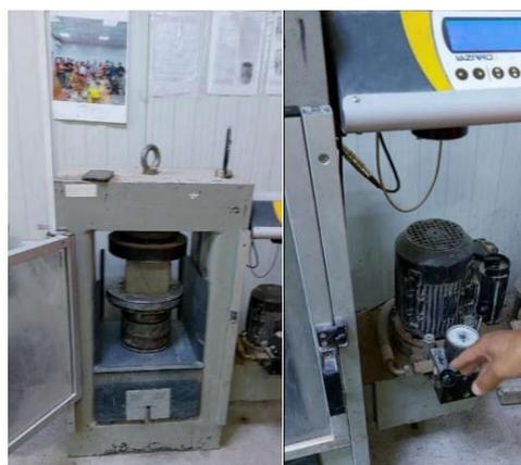
Рисунок 3.3 – Испытательный пресс Controls для испытания образцов
