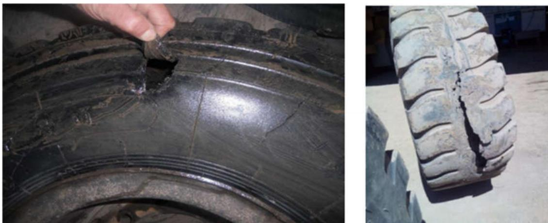
Рисунок 1.20 – Механические повреждения шин при эксплуатации в горных условиях
