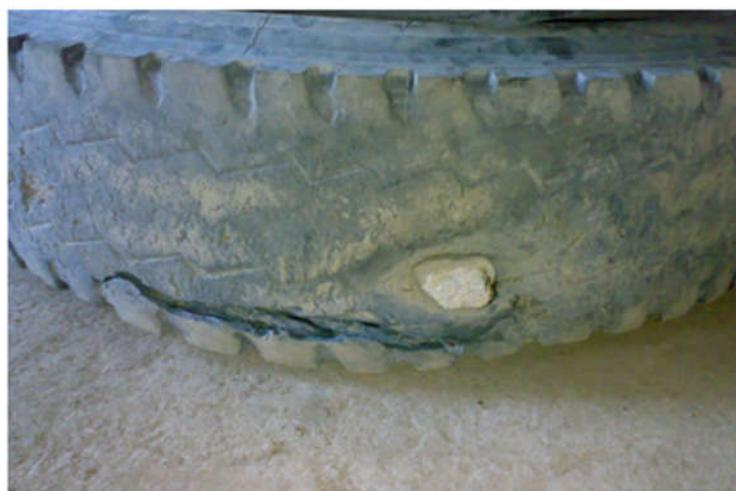
Рисунок 1.22 – Глухие проколы шин обломками твердых скальных пород
