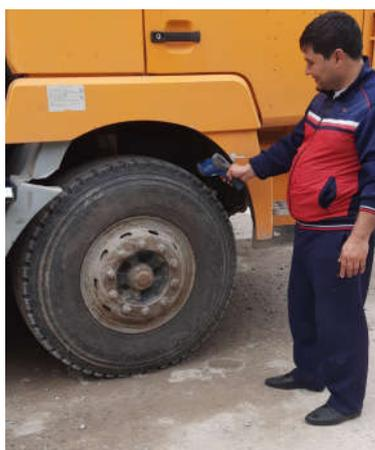
Рисунок 3.5– Процесс измерения температуры шин грузовых автомобилей при помощи пирометра DT- 9862
