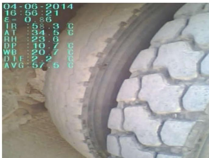
Рисунок 3.6 – Результат измерения температуры шин оптическим тепловизором
