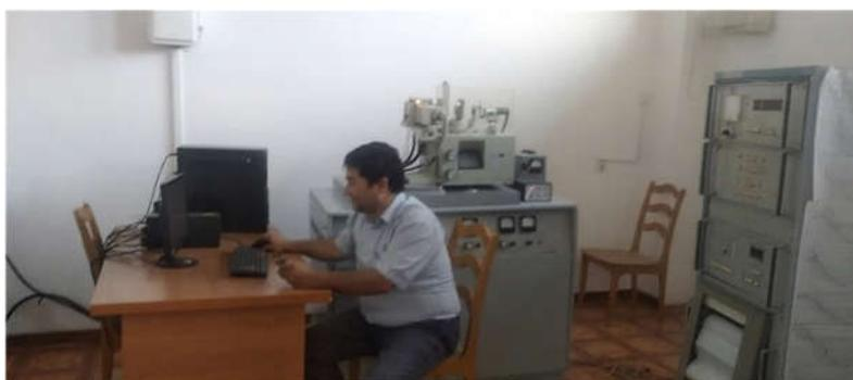
Рисунок 3.1-Рентгенографическое оборудование «Дрон-3»
