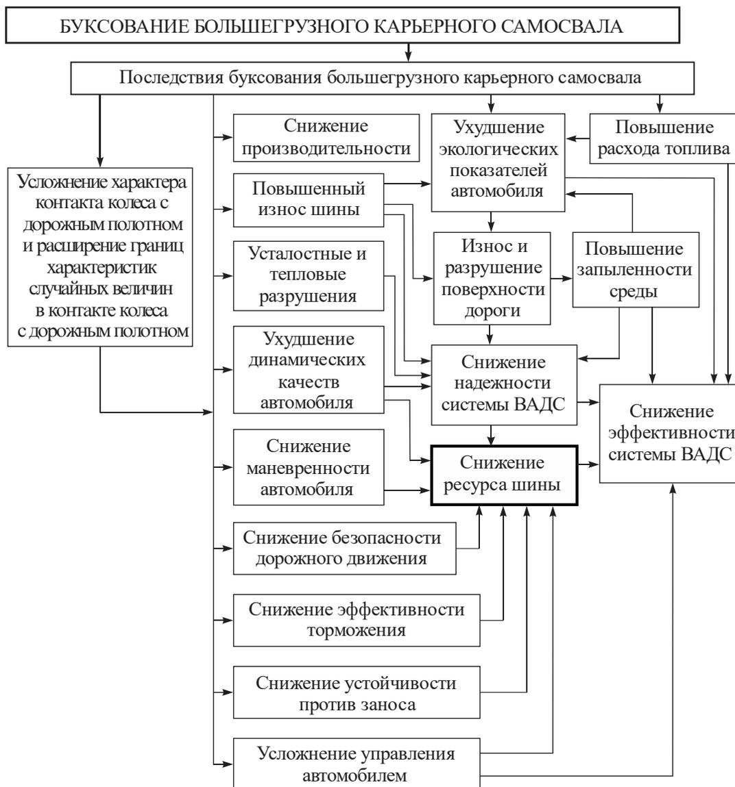
Рисунок. 1.12– Последствия буксования карьерного автосамосвала
