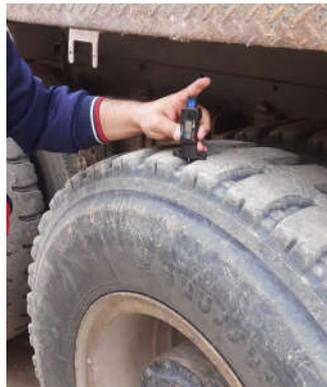
Рисунок 3.4—Измерение высоты рисунка протектора шин с помощью цифрового глубиномера
