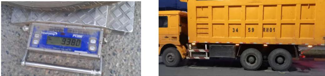
Рисунок 3.7 – Взвешивание автосамосвала при помощи подкладных автомобильных весов «Intercomp PT300»
