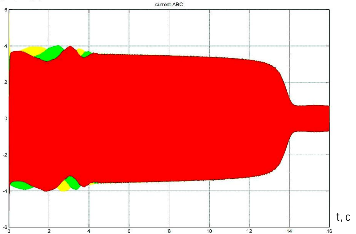
Рисунок 3.30. Графики токов статора I_A, I_B, I_C СД при прямом пуске
