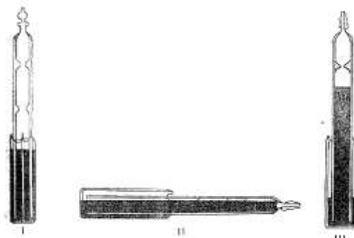
Рисунок 2.3.4. Схема принципа работы вискозиметра: I - исходное положение; II - вспомогательное положение; III - рабочее положение.
