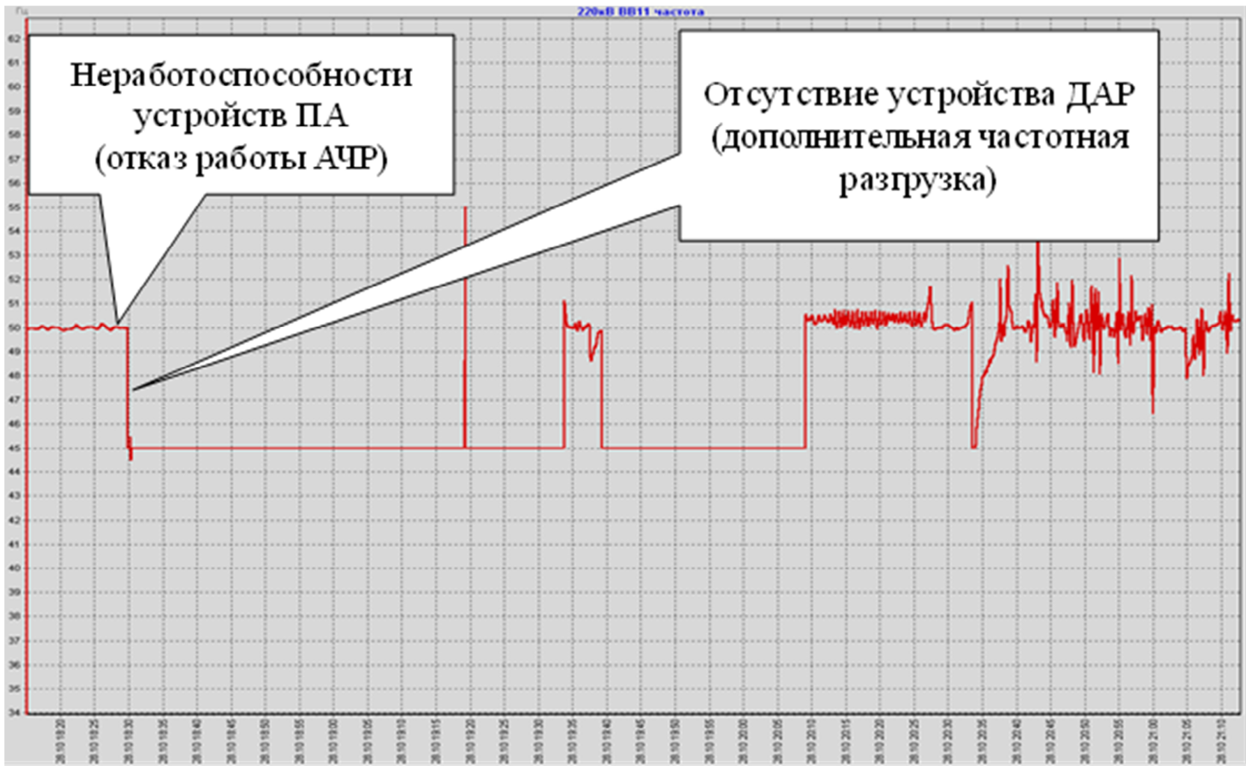
Рисунок 2.10. – Осциллограмма изменения частоты во времени (момент возникновения аварии с последующего восстановления нормального режима)
