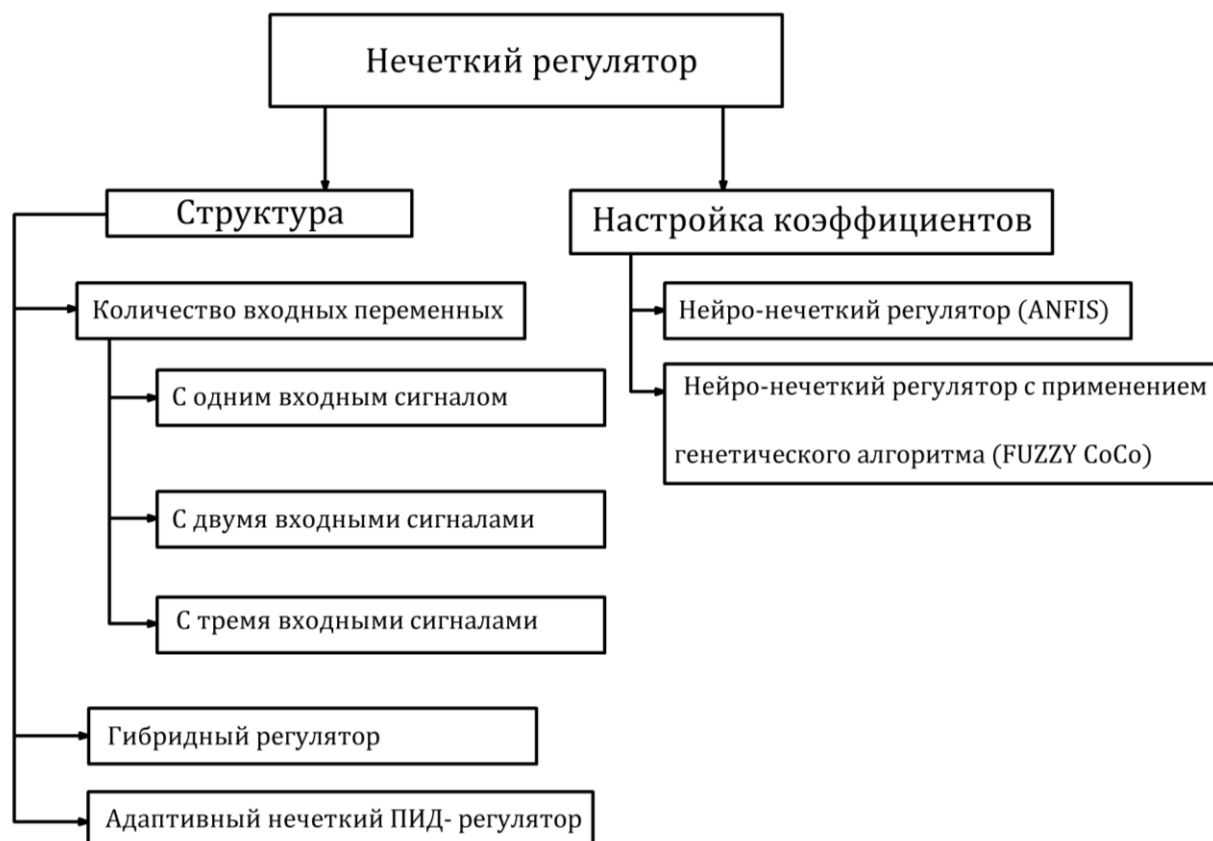
Рисунок 3.6 – Классификация интеллектуальных систем управления на базе нечеткой логики
