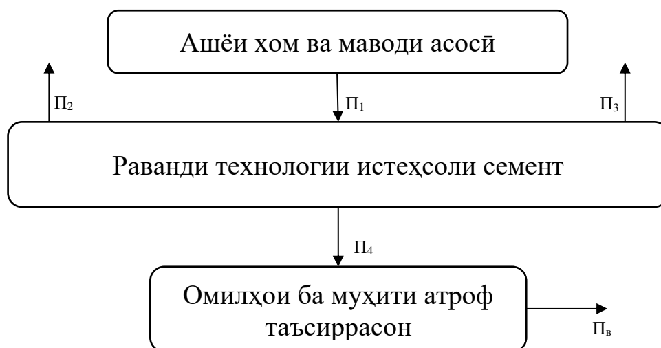
Расми 2.8 – Тавозуни моддии истеҳсоли семент: П 1 – ҷараѐни анбуҳи ашѐи хом ва маводи асосѐй; П 2 – ҷараѐни анбуҳи ашѐи хом ва маводи ґрирасон; П 3 – ҷараѐни анбуҳи маҳсулоти тайѐр; П 4 – ҷараѐни моддаҳои ифлоскунанда; П в – партовҳо ба атмосфера.
