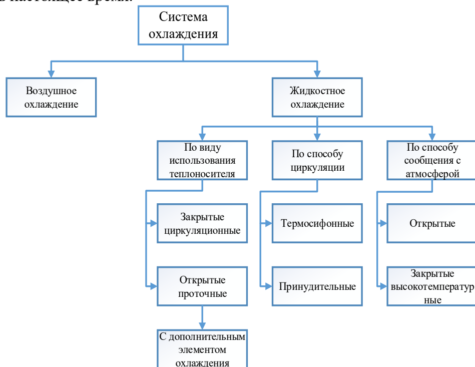
Рисунок 1 – Классификация систем охлаждения дизельных ДВС
