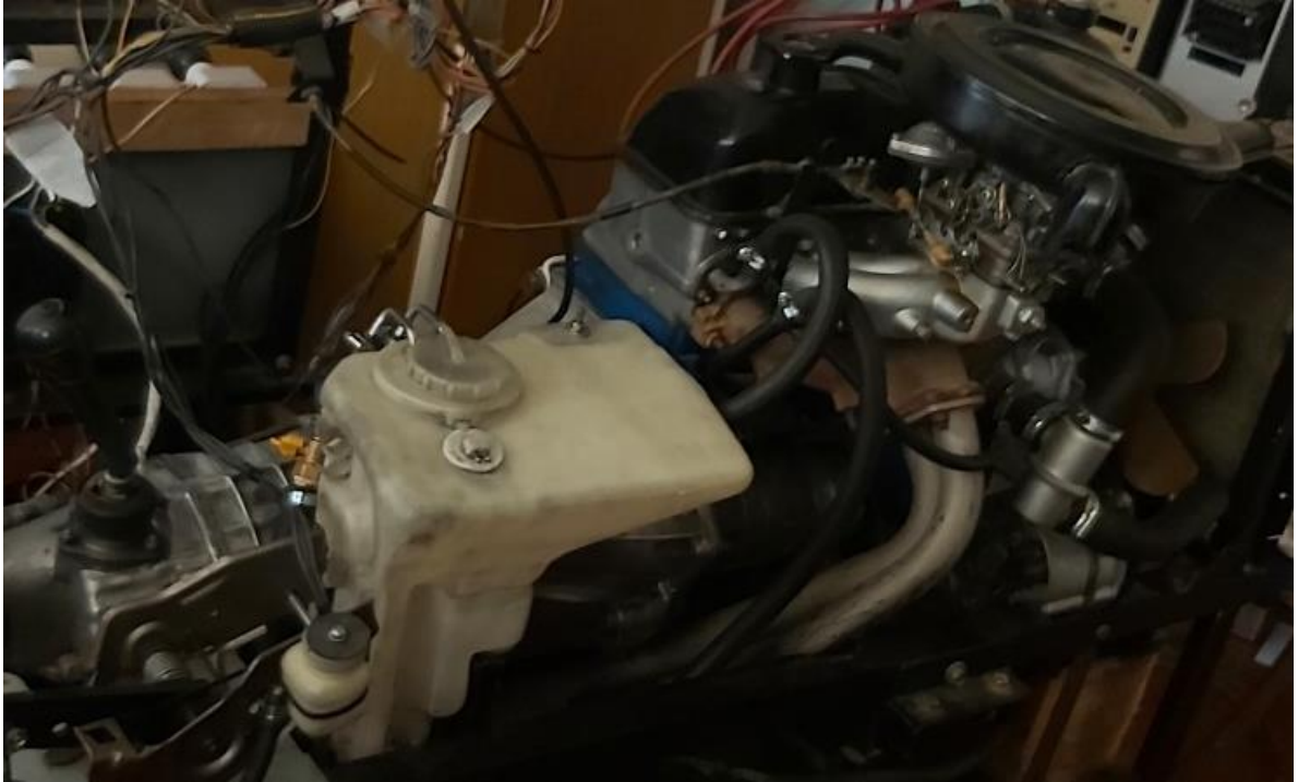
Рисунок 4.21. Устройство дополнительного охлаждения, используемый на стенде
