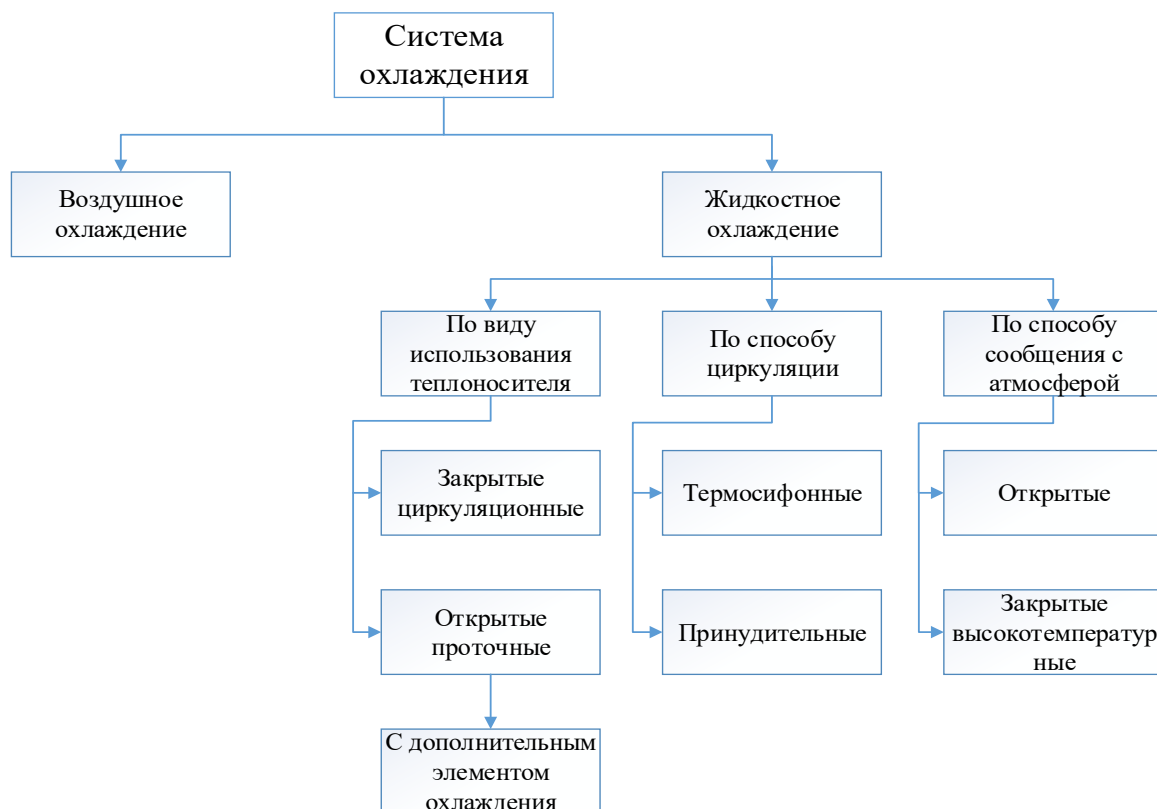
Рисунок 1.1 – Упрощенная классификация систем охлаждения ДВС
