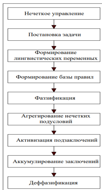
Рисунок 3.9 – Алгоритм нечеткого управления системой охлаждения ДВС
