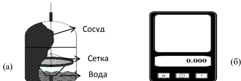
Рисунок 2. Установка для определения коэффициента адсорбции и массоотдачи а) установка; б) электронные весы; в) порядок заполнения системы.
