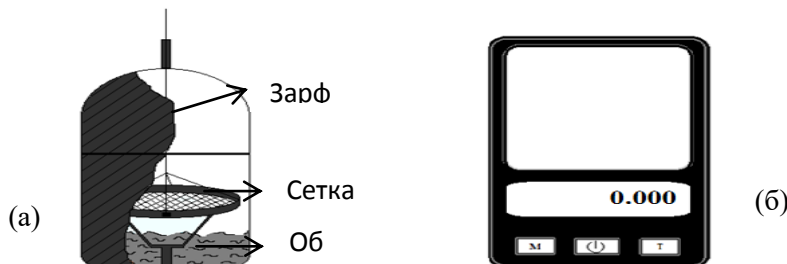
Расми 2. Дастгоҳ барои муайян кардани коэффитсенти адсорбсия ва массадиҳӣ а) дастгоҳ; б) тарозуи электронӣ; в) тартиби пур кардани система.
