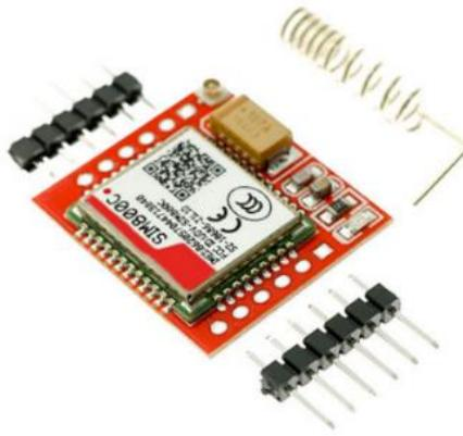
Расми 5 – Намуди умумии GSM-модули навъи SIM800C
