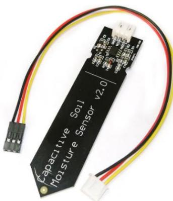
Рисунок 3 – Общий вид емкостного датчика типа V2.0
